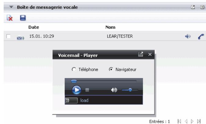
Une barre est au-dessus des commandes de la contrôle de la diffusion qui affiche la position approximative de la diffusion. Une barre d'état est au-dessous des commandes de la diffusion dans laquelle l'état
