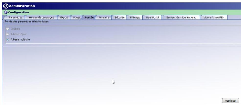
La portée **Globale** impose une configuration homogène sur l'ensemble des multisites gérés par le MiVoice 5000 Manager.
