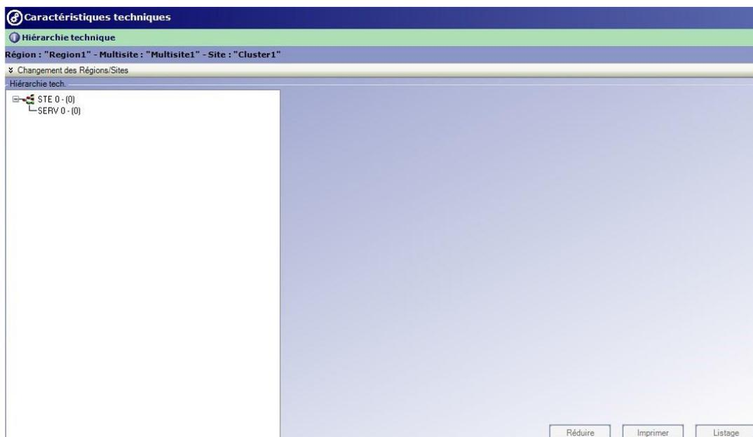
Le bouton **Listage** permet de lancer manuellement une action de listage des données de l'iPBX .
