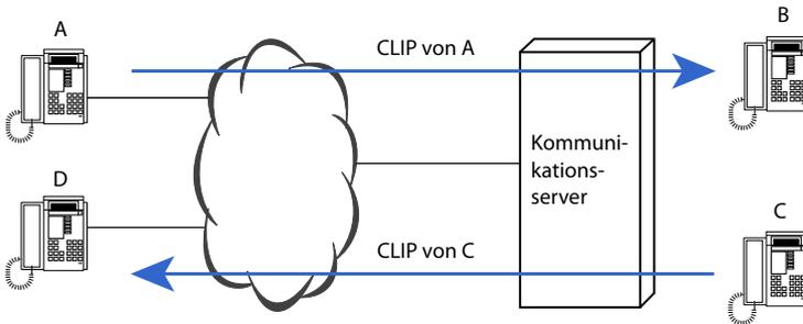
Fig. 32 CLIP einer ankommenden und einer abgehenden Verbindung
