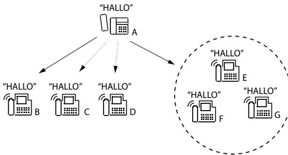
Fig. 215 Normale Durchsage an einen oder mehrere Benutzer oder an eine Durchsagegruppe
