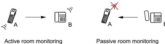
Fig. 235 Raumüberwachung (Babywache)
