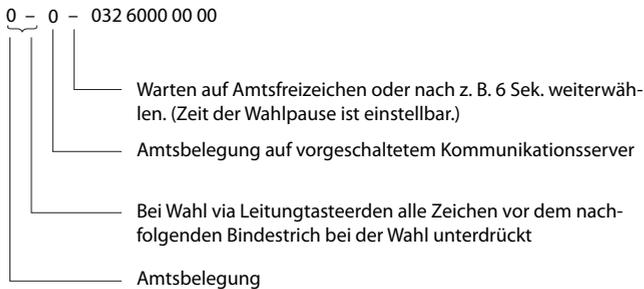
Fig. 16 Beispiel für das Amtszugangspräfix über vorgeschalteten Kommunikationsserver
