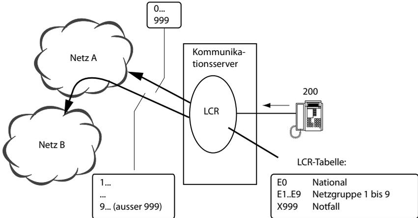
Fig. 104 Lenkung der Notfall-Nummer 999
