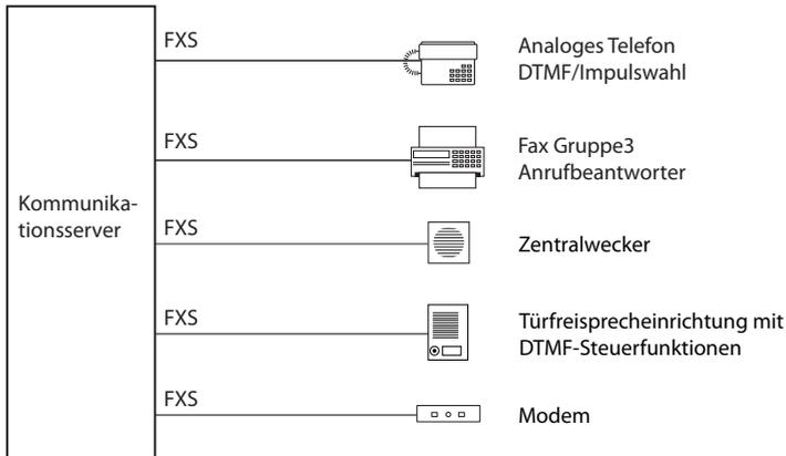
Fig. 21 Endgeräteschnittstelle FXS
