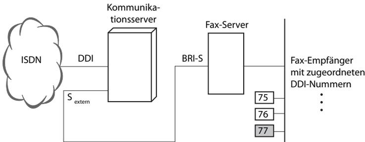
Fig. 10 Direct Dialling Out (DDO) zu einem Faxserver
