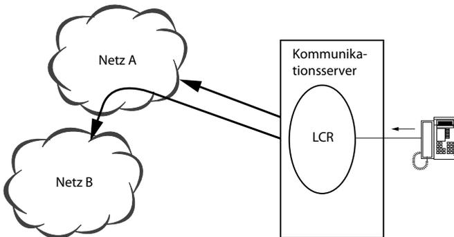
Fig. 101 Indirekter Zugriff auf Netz B via Netz A mit LCR
