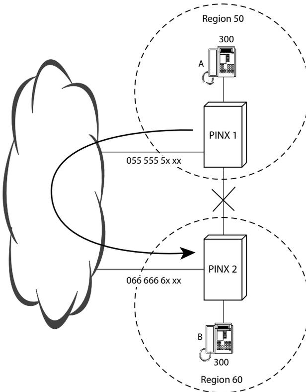
Fig. 124 Konfigurationsbeispiel für eine Überlauflenkung über das öffentliche Netz
