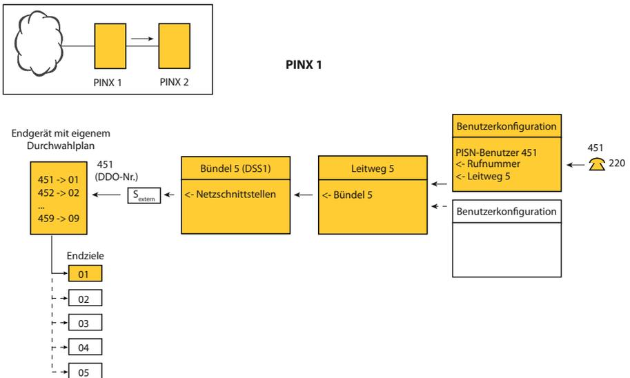
Fig. 99 Anruf zu einem Endgerät mit eigenem Durchwahlplan
