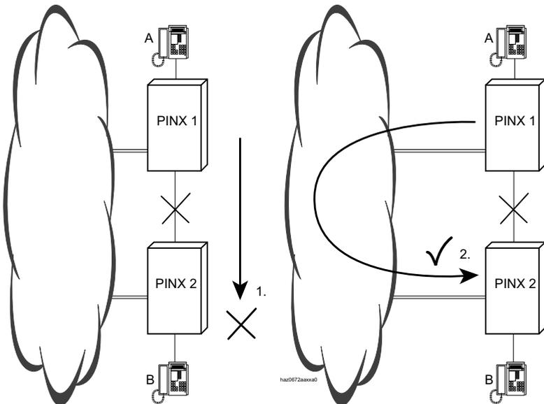
Fig. 123 Überlauf über das öffentliche Netz. Hierzu wird die LCR-Funktion eingesetzt
