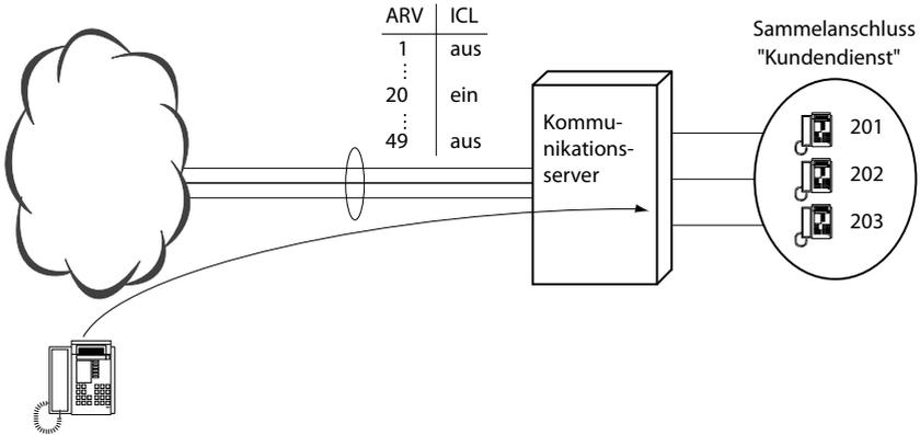
Fig. 153 ICL kann in jedem Anrufverteilungselement ein-, ausgeschaltet werden
