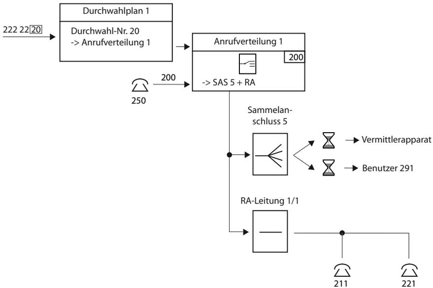
Fig. 74 Anwendung Reihenapparate und Sammelschluss
