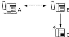
Fig. 197 Verbindung in Halten legen
