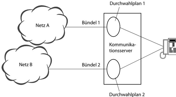
Fig. 55 Mehrere Durchwahlpläne pro Kommunikationsserver / PINX
