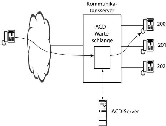
Fig. 79 Anruf lenkung des Kommunikationsservers durch ACD-Server gesteuert
