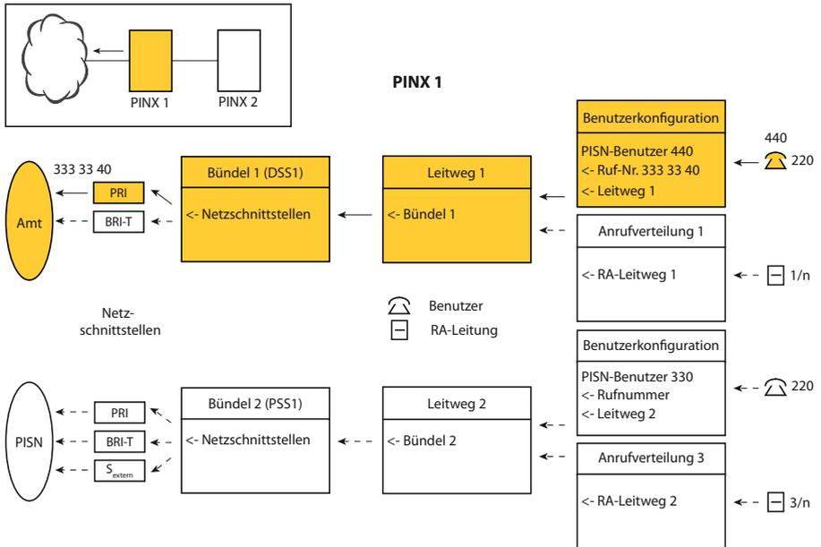
Fig. 95 Lenkung eines Anrufs an einen virtuell vernetzten PISN-Benutzer über das öffentliche Netz
