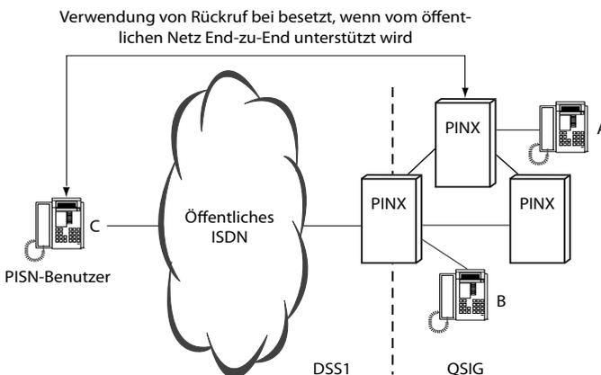
Fig. 182 Verwendung eines Leistungsmerkmals über das öffentliche Netz
