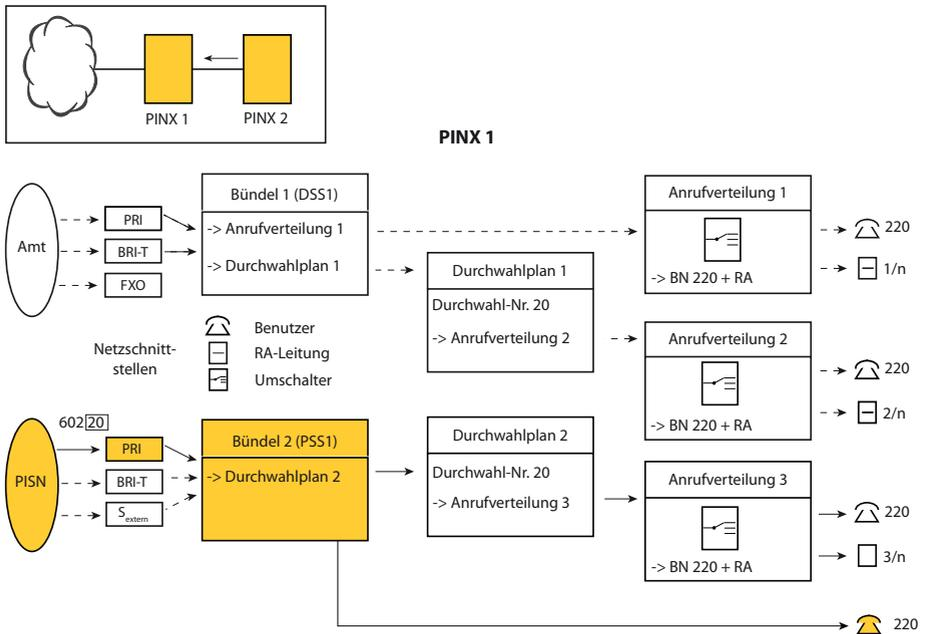
Fig. 87 Lenkung eines Anrufs aus dem privaten Festnetz ohne Durchwahl
