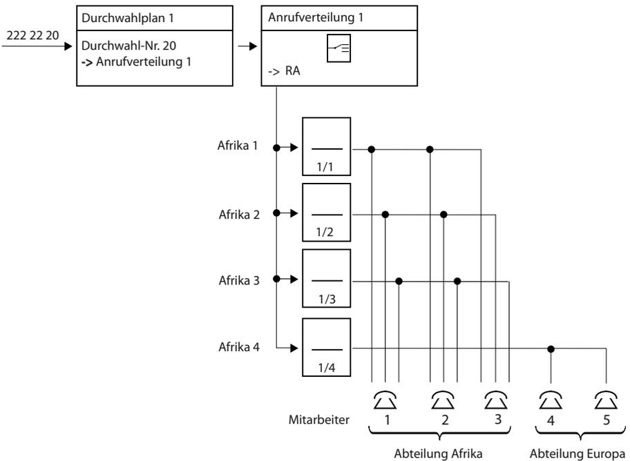
Fig. 75 Reihenapparate-Applikation Reisebüro
