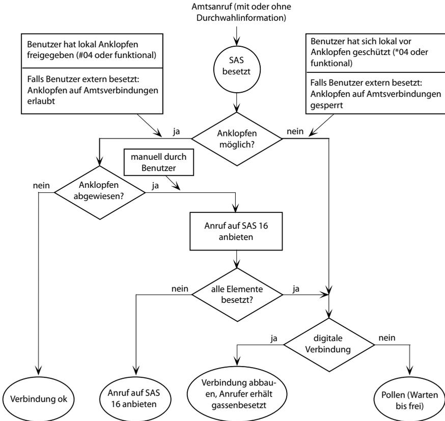
Fig. 89 Anrufverteilung bei besetztem Sammelanschluss
