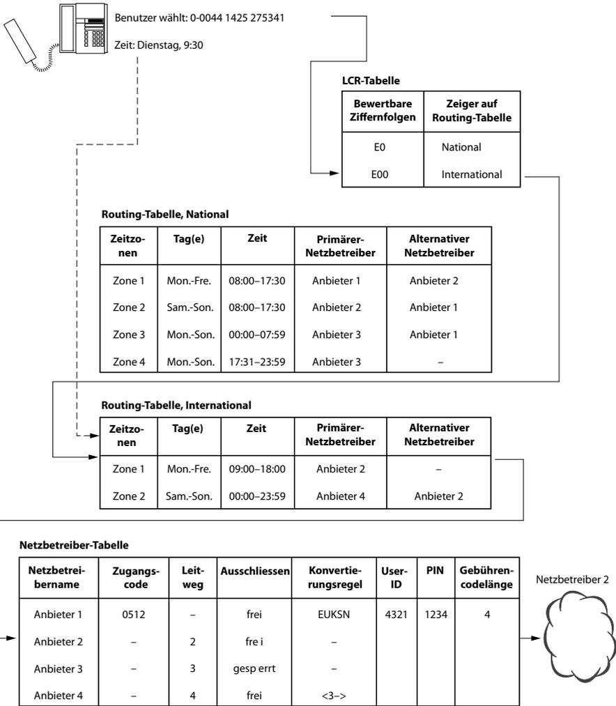
Fig. 103 Beispiel einer Anruflenkung mit der LCR-Funktion
