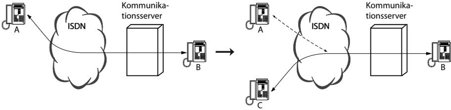
Fig. 113 Externe Verbindung und anschließendes Halten und Rückfragen
