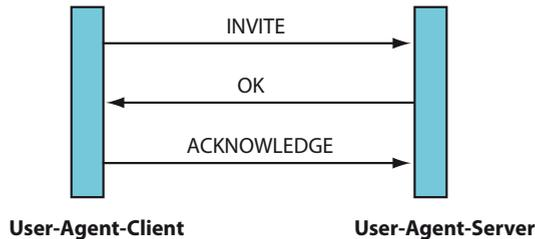
Fig. 12 Direkter Verbindungsaufbau
