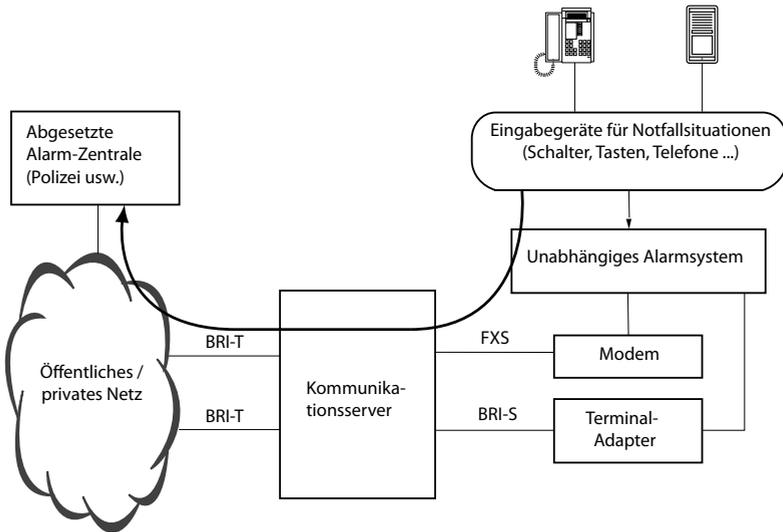
Fig. 97 Übersicht einer Konfiguration für Notfall-Anwendungen
