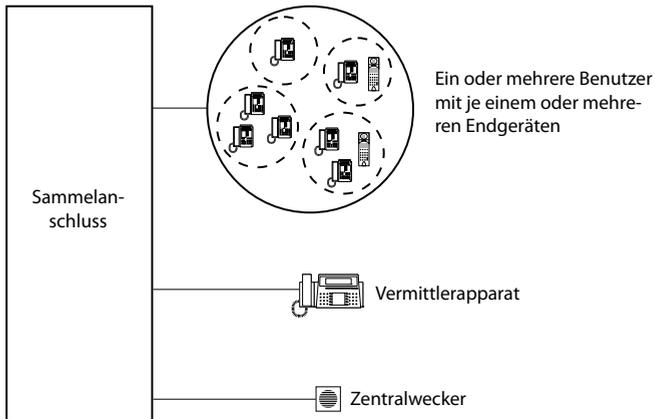
Fig. 64 Elemente im Sammelschluss
