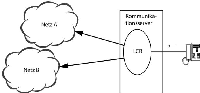
Fig. 100 Direkter Zugriff auf Netz A oder B mit LCR
