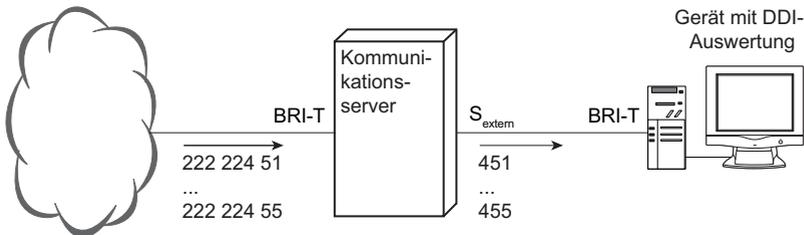
Fig. 2 BRI-S extern in einer DDO-Konfiguration
