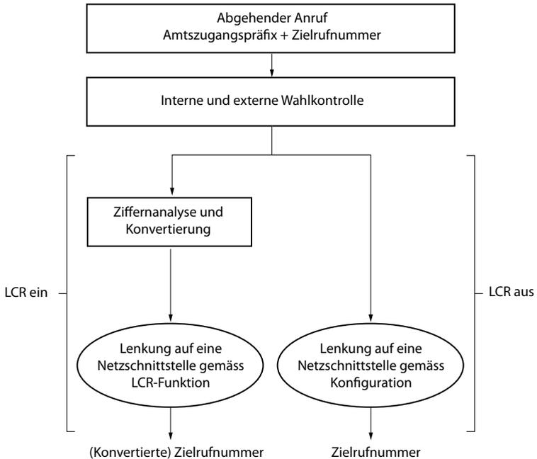
Fig. 102 Abgehender Amtsverkehr mit LCR
