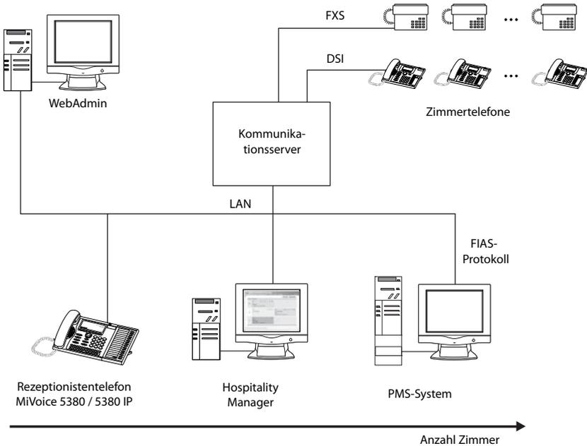
Fig. 245 Überblick der Konfigurations- und Bedienmöglichkeiten
