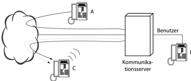
Fig. 185 Digitale Netzschnittstelle ohne Durchwahl oder Durchwahl-Nummer an Benutzer
