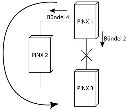
Fig. 122 Überlaufung im privaten Festnetz durch sinnvolle Zuordnung der Bündel in der Leitweg-Konfiguration
