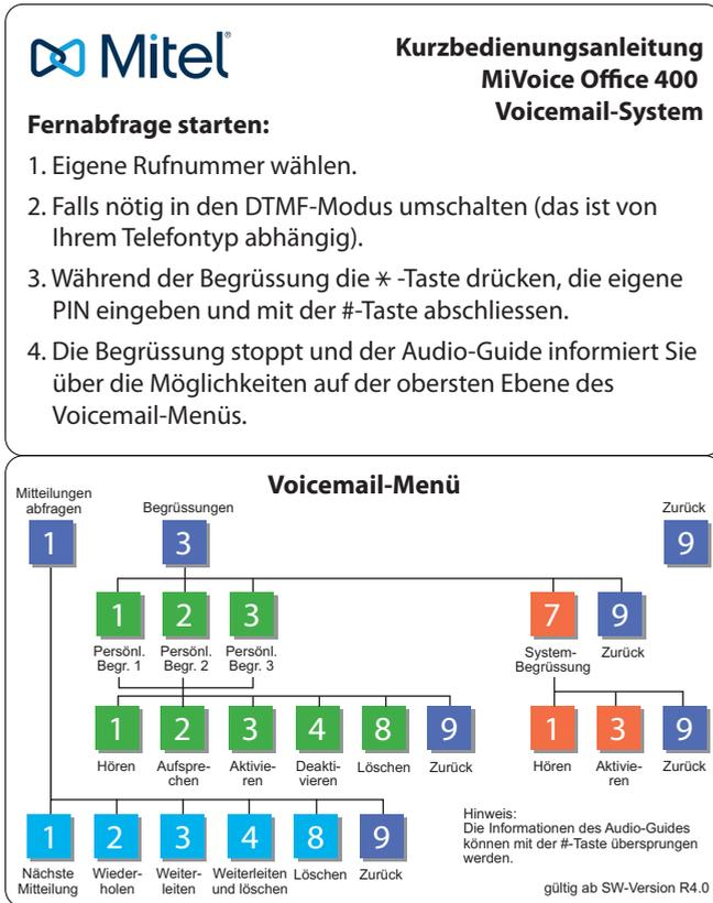
Fig. 208 Kurzbedienungsanleitung
