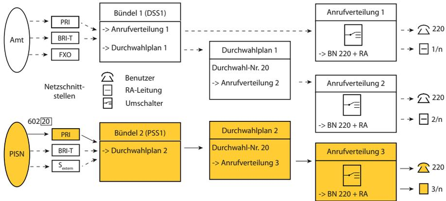
Fig. 86 Lenkung eines Anrufs aus dem privaten Festnetz mit Durchwahl
