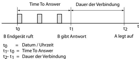
Fig. 161 Dauer der Rufphase und der aufgebauten Verbindung
