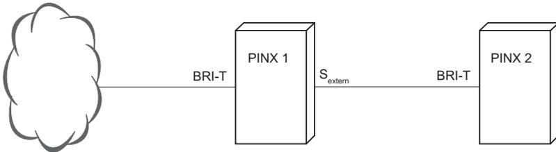
Fig. 1 BRI-S extern im privaten Festnetz: PINX-PINX-Verbindung
