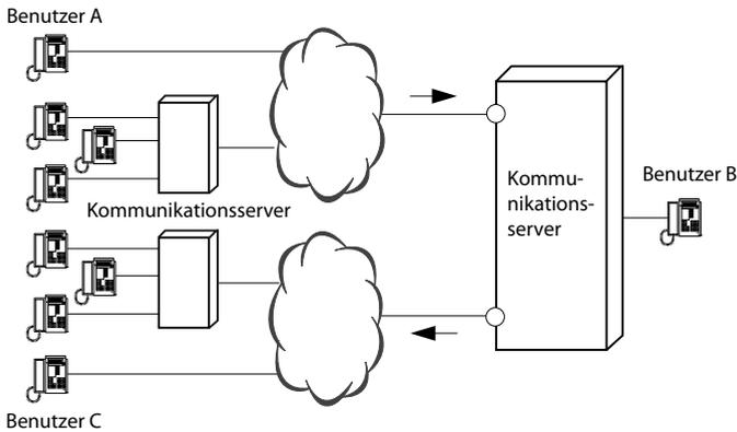
Fig. 109 Verbinden eines ankommenden und eines abgehenden Anrufs
