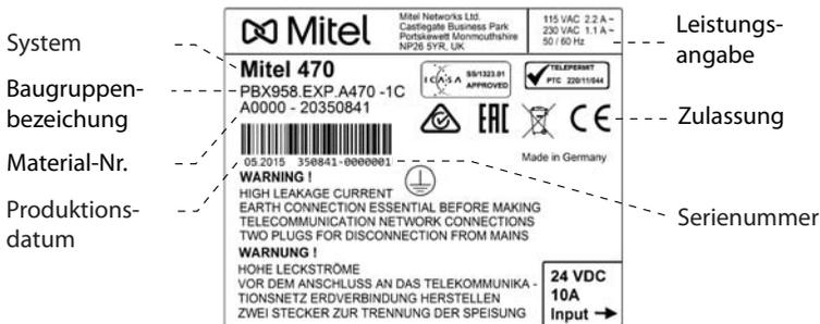
Fig. 92 Typenschild (Beispiel Kommunikationsserver Mitel 470)
