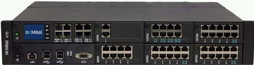
Fig. 1 Mitel 470 mit Applikationskarte und einigen Schnittstellenkarten
