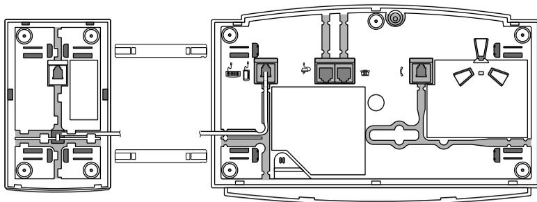
1. Desconectar el cordón del teléfono del conector situado en la parte inferior del teléfono.
