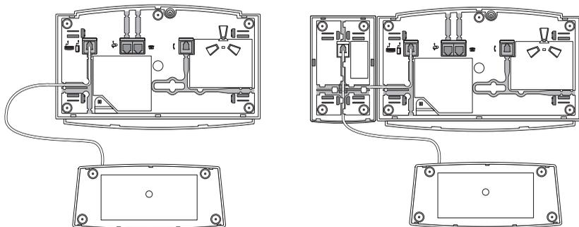
1. Desconectar el cordón del teléfono del conector situado en la parte inferior del teléfono.
