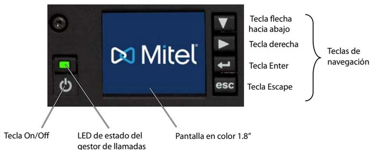
Fig. 87 Panel de visualización y control de Mitel 470
