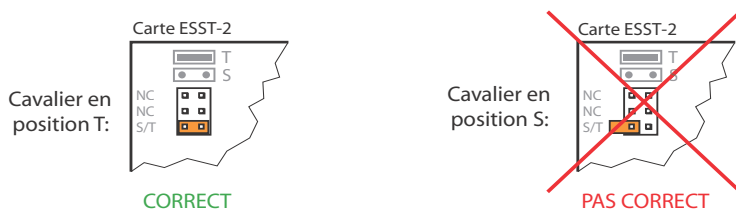
Fig. 24 Position du cavalier sur la carte ESST
