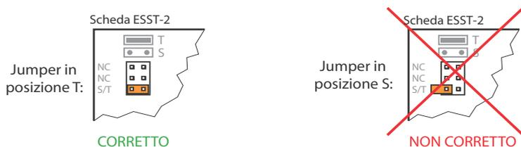
Fig. 24 Posizione dei jumper sulla scheda ESST
