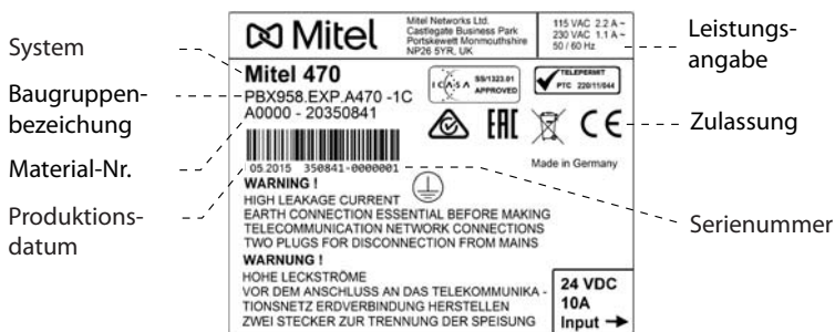
Fig. 89 Typenschild (Beispiel Kommunikationsserver Mitel 470)
