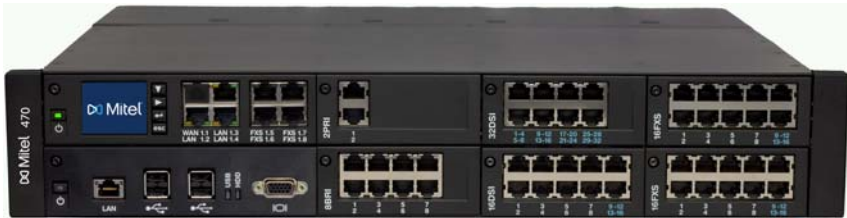
Fig. 1 Mitel 470 mit Applikationskarte und einigen Schnittstellenkarten
