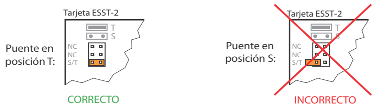
Fig. 24 Posición del puente en la tarjeta ESST
