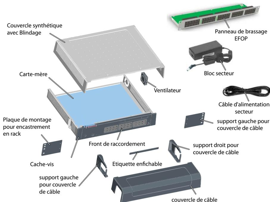
Fig. 11 Composants système avec options de montage
