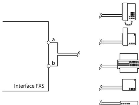
Fig. 53 Connexion pour le mode FXS : Téléphone/Fax:
