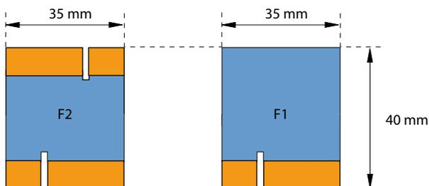
Fig. 86 Dimensions de l'adaptateur de câblage (forme de construction F)
