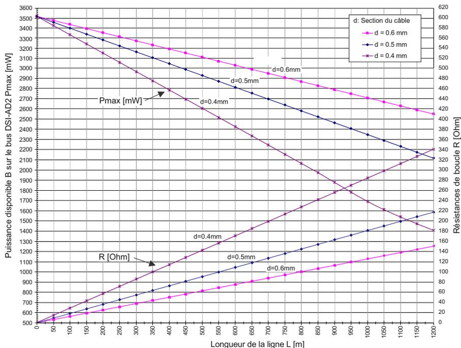
Fig. 44 Puissance disponible B sur le bus DSI-AD2
