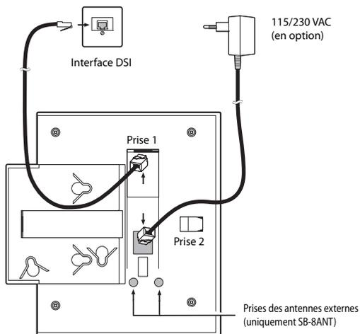
Fig. 69 Dos des unités radio avec points de raccordement
