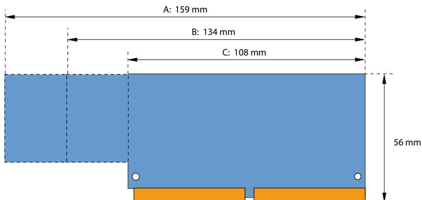
Fig. 84 Dimensions des cartes d'interface (formes de construction A, B , C)
