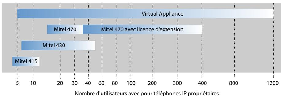
Fig. 3 Serveur de communication MiVoice Office 400 et sa capacité d'extension
