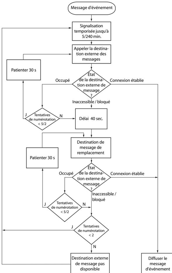
Fig. 81 Diagramme fonctionnel de la signalisation d'un message d'événement à une destination externe
