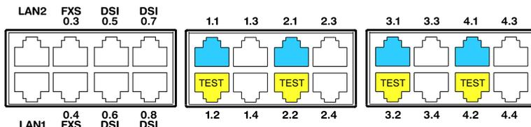
Fig. 35 Possibilités de raccordement des interfaces réseau T2
