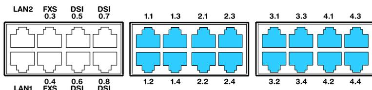
Fig. 31 Possibilités de raccordement des interfaces réseau S0/T0
