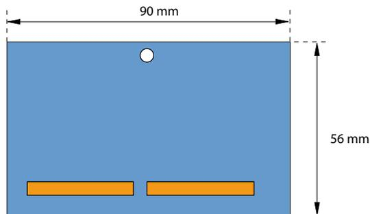
Fig. 85 Dimension des modules système (forme de construction D)
