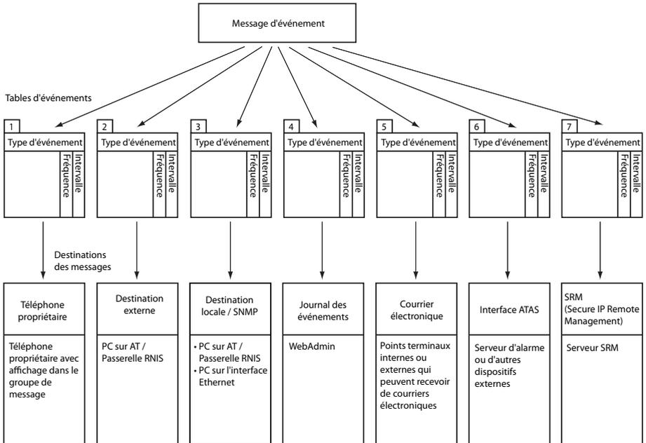
Fig. 80 Principe de distribution d'un message d'événement
