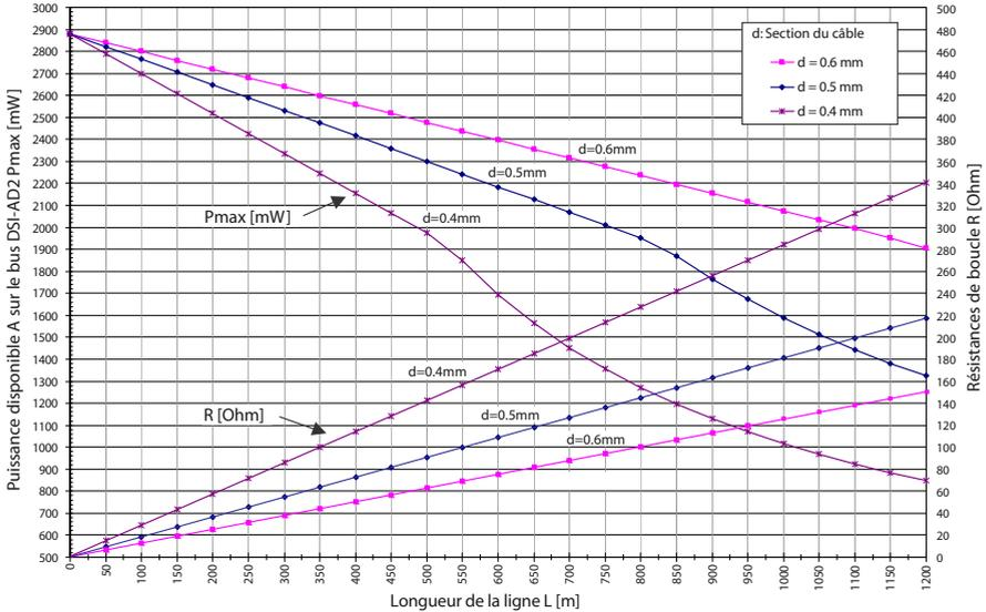
Fig. 43 Puissance disponible A sur le bus DSI-AD2
