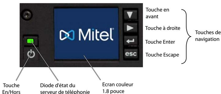
Fig. 84 Panneau d'affichage et de commande Mitel 470
