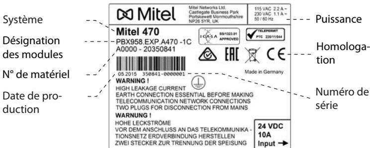
Fig. 89 Plaquette signalétique (exemple du serveur de communication Mitel 470)
