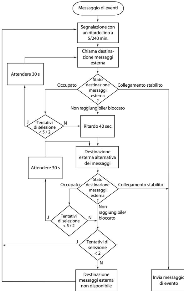
Fig. 11 Diagramma di flusso per la segnalazione di un messaggio di evento ad una destinazione esterna dei messaggi
