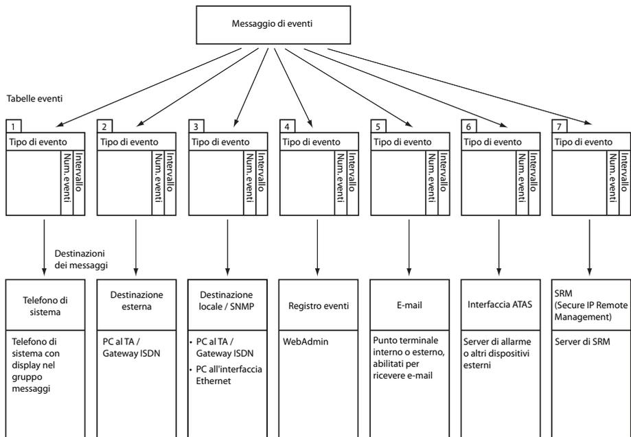
Fig. 10 Principio di distribuzione di un messaggio di evento
