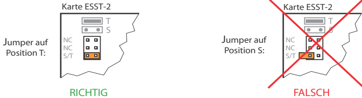
Fig. 24 Jumper-Position auf der Karte ESST
