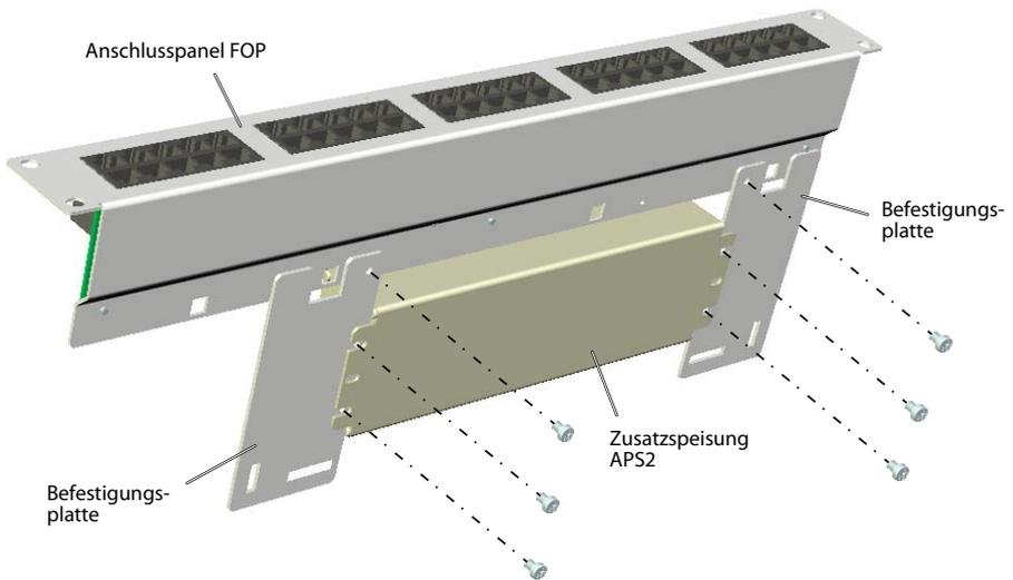
Fig. 25 Verteilpanel mit montierter Zusatzspeisung (Ansicht von unten)
