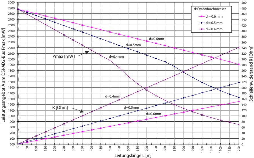
Fig. 47 Verfügbare Leistung Fall A am DSI-AD2-Bus
