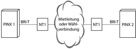
Fig. 38 Basisanschluss BRI-T Vernetzung mit Mietleitung oder Wählverbindung
