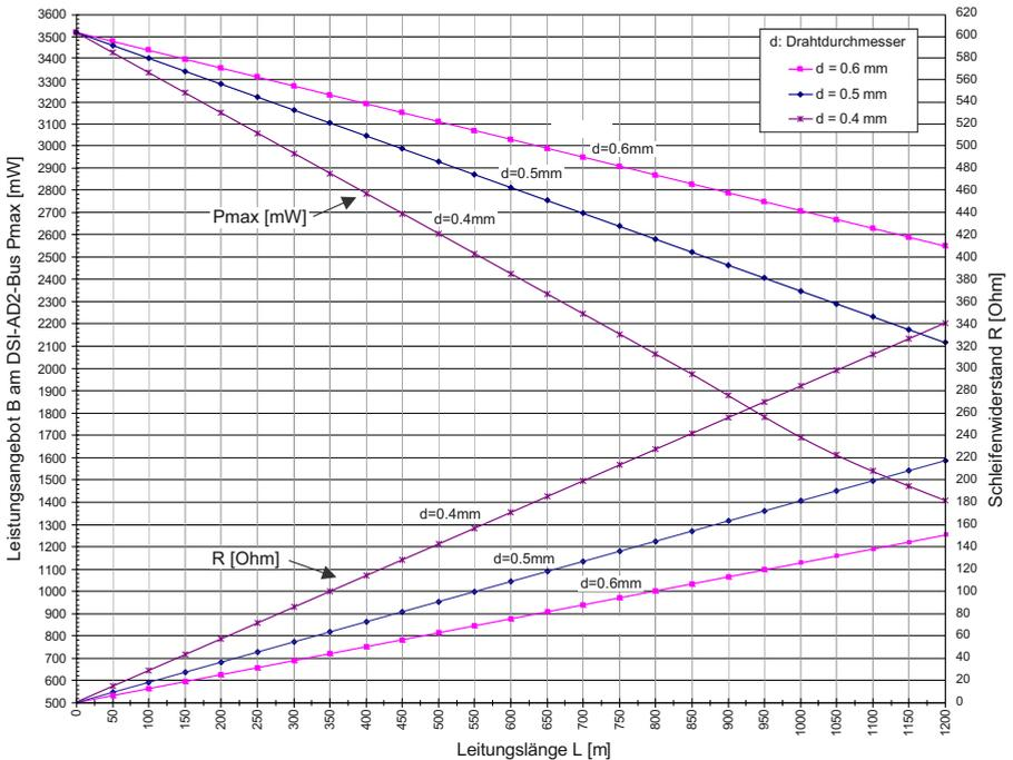
Fig. 48 Verfügbare Leistung Gehäuse B am DSI-AD2-Bus
