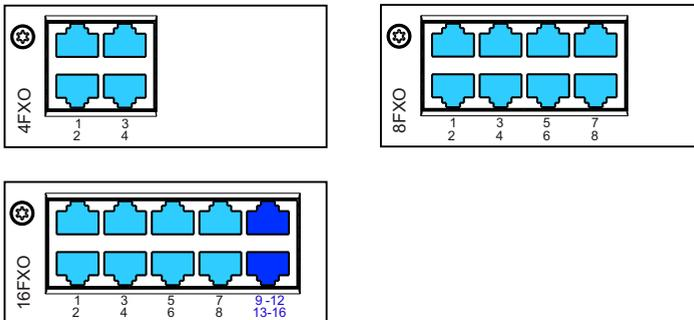
Fig. 44 Anschlussmöglichkeiten FXO-Netzschnittstellen
