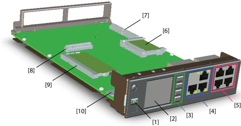
Fig. 9 Schnittstellen, Anzeige- und Bedienelemente der Call-Manager-Karte CPU1
