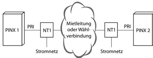
Fig. 43 Primäratenanschluss PRI Vernetzung mit Mietleitung oder Wählverbindung
