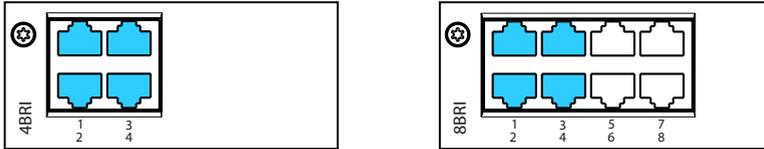
Fig. 49 Anschlussmöglichkeiten BRI-S-Endgeräteschnittstellen
