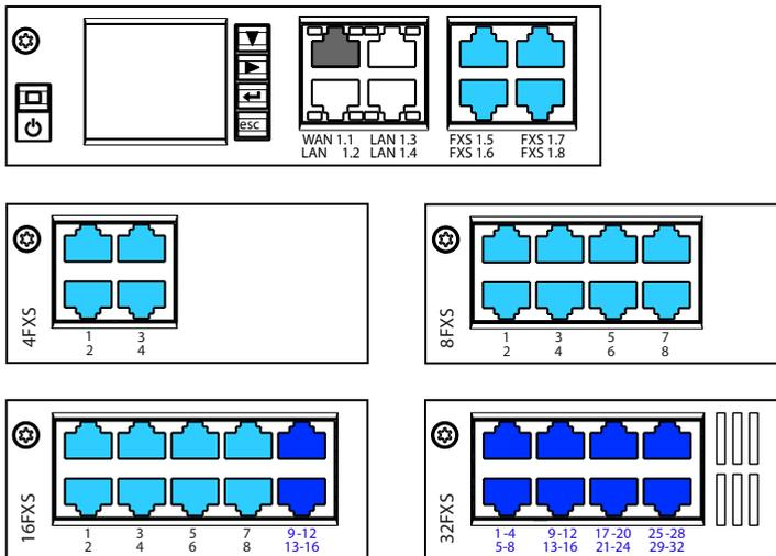
Fig. 56 Anschlussmöglichkeiten FXS-Endgeräteschnittstellen
