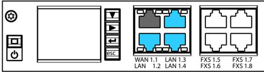
Fig. 67 Anschlussmöglichkeiten Ethernet-Schnittstellen
