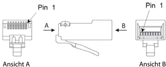
Fig. 31 Pin-Nummerierung RJ45-Stecker
