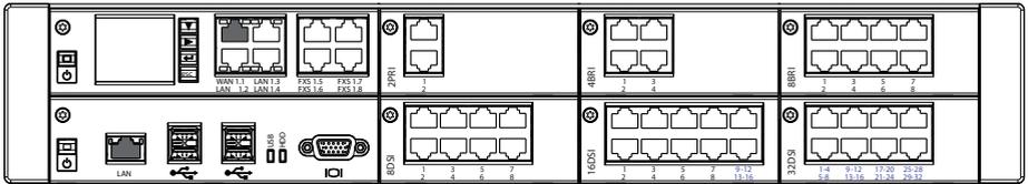
Fig. 34 Schnittstellen der Anschlussfront mit Portbezeichnung (Beispiel)
