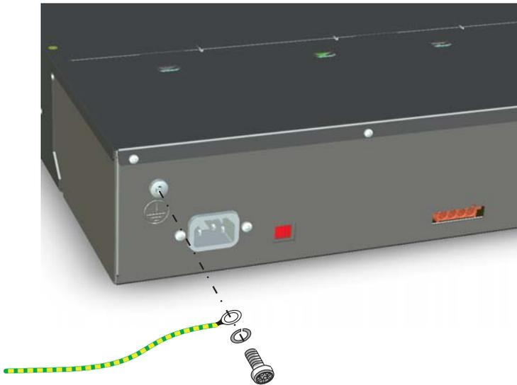
Fig. 21 Erdungsanschluss
