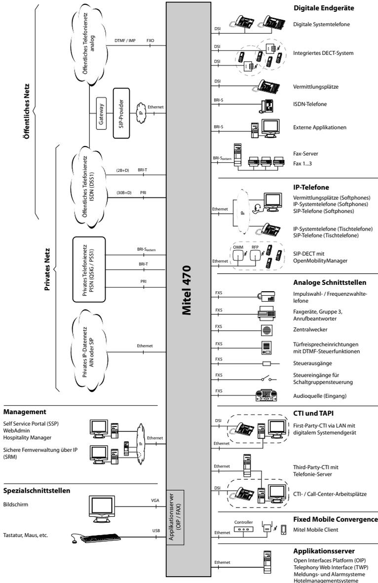
Fig. 4 Schnittstellen mit möglichen Endeinrichtungen im Überblick
