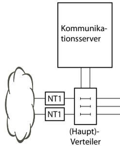
Fig. 30 Anschluss über Hauptverteiler
