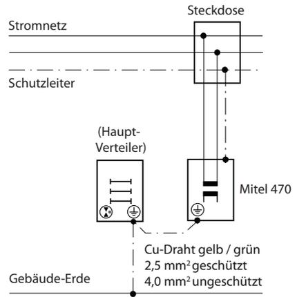
Fig. 22 Erdung des Kommunikationsservers bei Direktanschluss und Indirektanschluss
