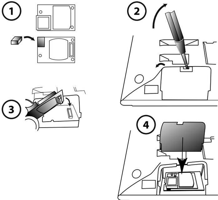
Fig. 69 Montage Bluetooth-Modul
