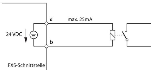
Fig. 62 Beschaltung für FXS-Modus: Steuerausgang
