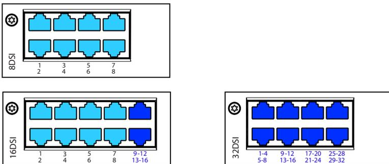
Fig. 45 Anschlussmöglichkeiten DSI-Endgeräteschnittstellen
