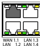
Fig. 68 Status LED Ethernet-Schnittstellen
