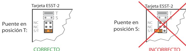
Fig. 24 Posición del puente en la tarjeta ESST
