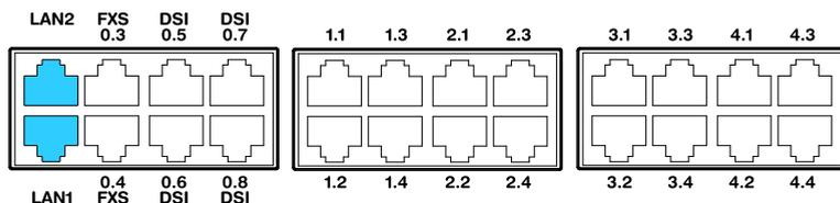
Fig. 63 Possibilités de raccordement des interfaces Ethernet
