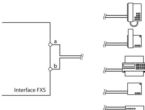
Fig. 53 Connexion pour le mode FXS : Téléphone/Fax:
