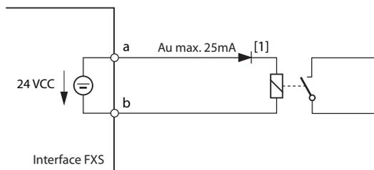
[1] La diode est nécessaire pour éviter des tensions indésirables sur la sortie de commande durant la phase de mise en marche du serveur de communication.
