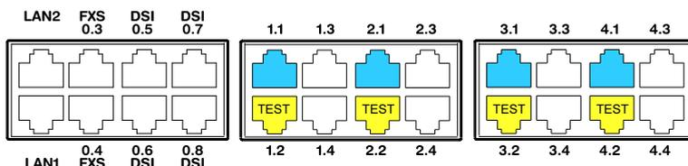
Fig. 35 Possibilités de raccordement des interfaces réseau T2
