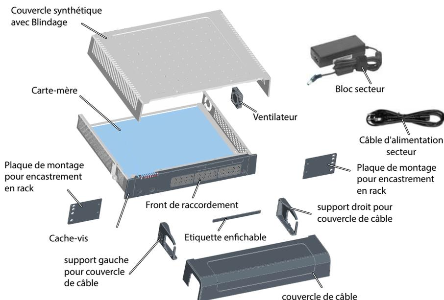
Fig. 11 Composants système avec options de montage
