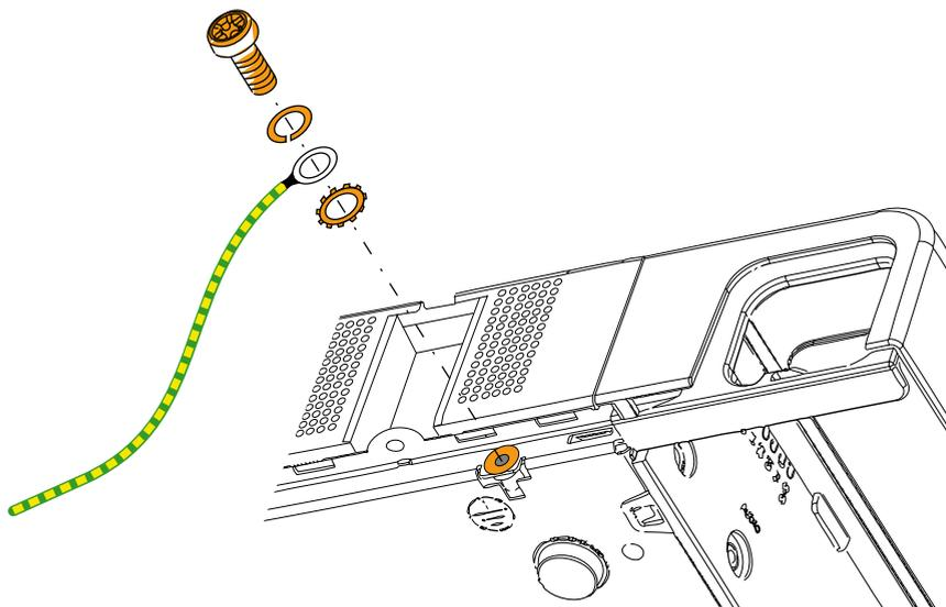
Fig. 19 Raccordement de la mise à terre
