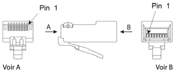
Fig. 27 Numérotation des broches du connecteur RJ45
