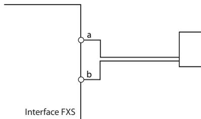
Fig. 54 Connexion pour le mode FXS : Interphone à 2 fils
