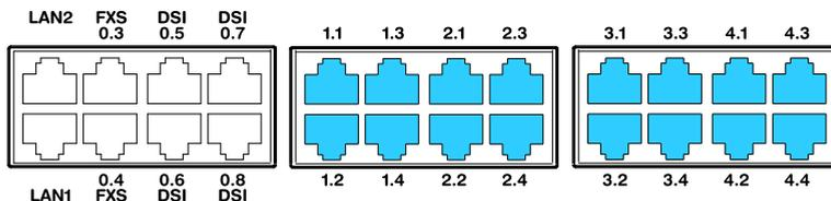
Fig. 40 Possibilités de raccordement des interfaces réseau FXO
