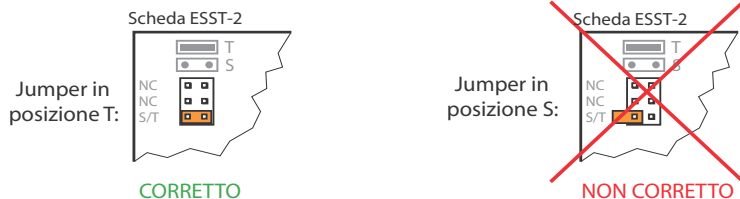
Fig. 24 Posizione dei jumper sulla scheda ESST
