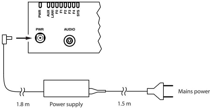
Fig. 22 Encendido del servidor de comunicaciones desde la toma
