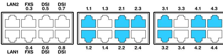
Fig. 58 Interfaces de la tarjeta de opciones ODAB
