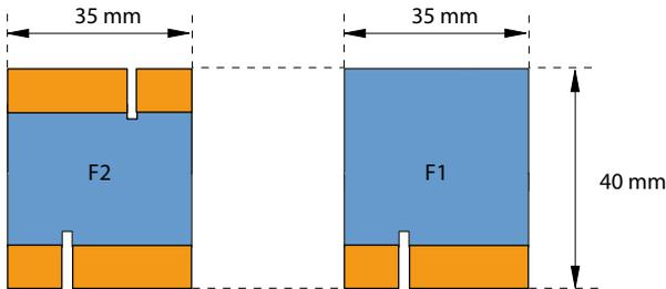
Fig. 84 Dimensiones del adaptador de cableado (dibujo F)
