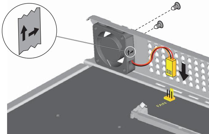
Fig. 17 Instalación del ventilador en Mitel 430
