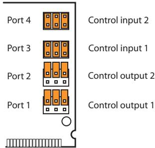
Fig. 61 Configuración de puentes para salidas y entradas de control
