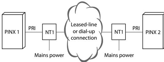
Fig. 39 Acceso primario PRI, conectado mediante línea dedicada o conexión telefónica
