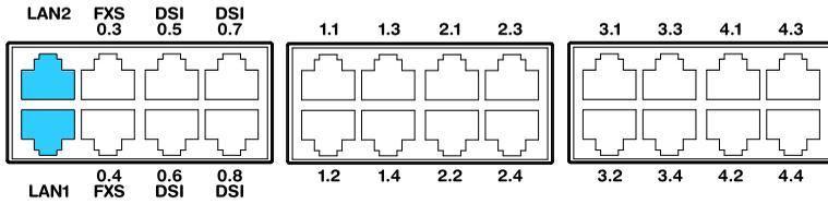
Fig. 63 Posibilidades de conexión para interfaces Ethernet
