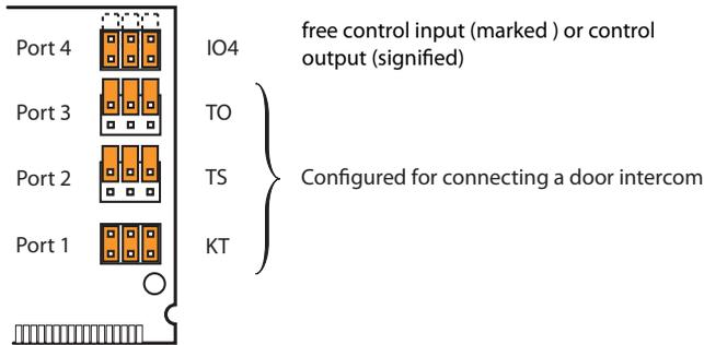
Fig. 59 Configuración de puentes para la conexión de un intercomunicador de puerta
