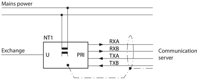
Fig. 36 Interfaz de acceso primario PRI en NT1
