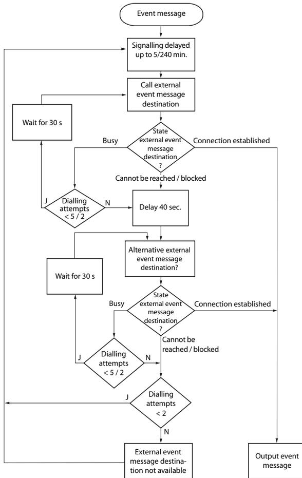
Fig. 79 Diagrama de flujo de la señalización de un mensaje de evento a un destino de señal externo
