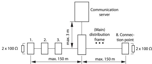
Fig. 47 Bus S, corto, en forma de V
