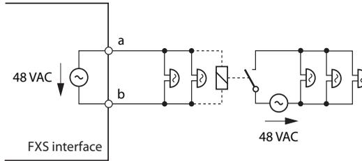
Fig. 57 Conexión para el modo FXS: Llamada general
