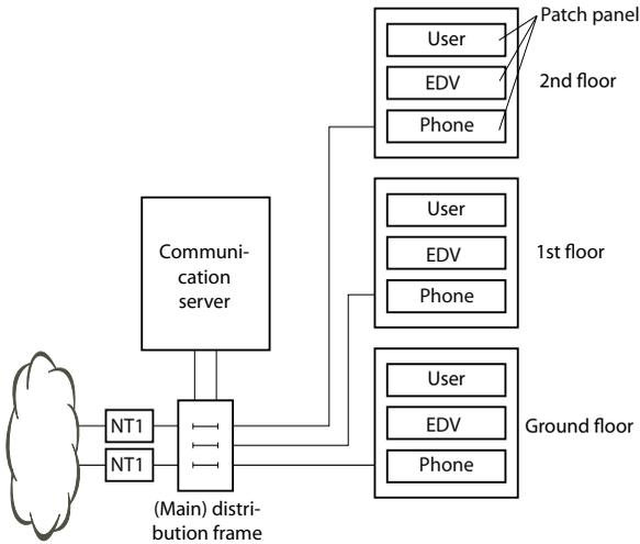
Fig. 28 Conexión a un UBC a través de una placa de distribución principal (ejemplo)
