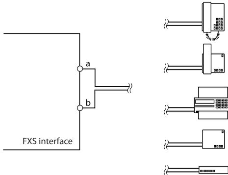
Fig. 53 Conexión para el modo FXS: Teléfono/fax
