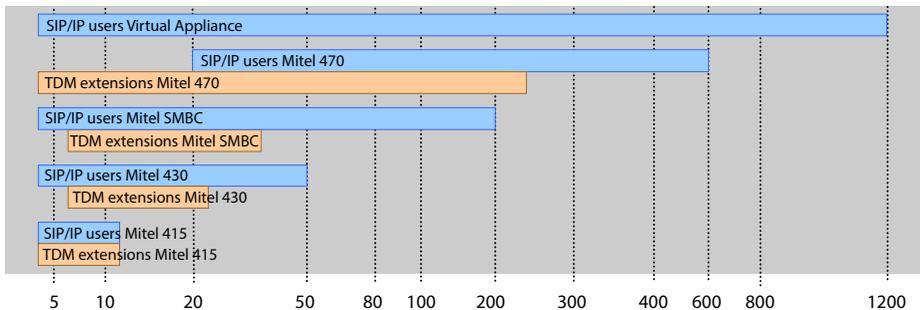
Fig. 3 Capacidad de expansión máxima para usuarios con teléfonos SIP/IP y extensiones TDM (FXS, DSI, BRI-S)
