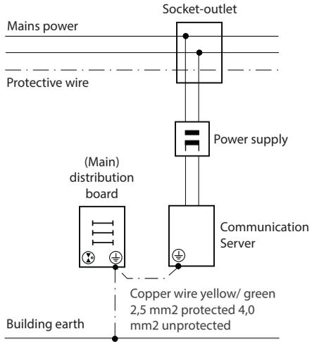
Fig. 20 Puesta a tierra del servidor de comunicaciones en caso de conexión indirecta y conexión directa
