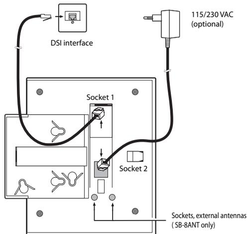
Fig. 67 Parte inferior de las unidades de radio, con puntos de conexión
