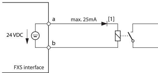
[1] El diodo es necesario para evitar voltajes no deseados en la salida de control durante la fase de inicio del servidor de comunicaciones.
