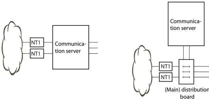
Fig. 25 Cableado directo (izquierda) y cableado indirecto (derecha)
