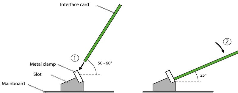
Fig. 23 Instalación de una tarjeta de interfaz
