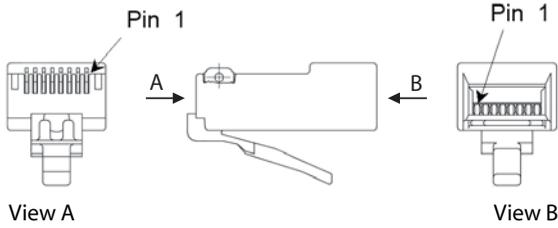
Fig. 27 Numeración de pines de un conector RJ45
