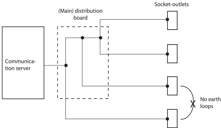
Fig. 21 Principio de la estructura en árbol
