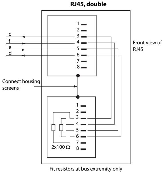
Fig. 51 Conexión RJ45, toma doble
