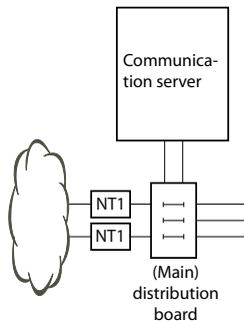
Fig. 26 Conexión a través del panel de distribución principal
