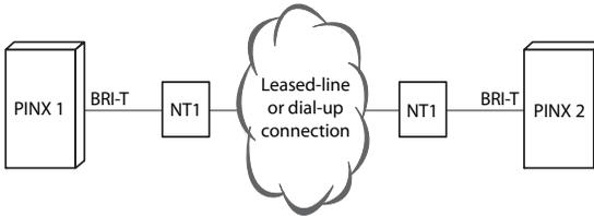
Fig. 34 Interfaz de acceso básico BRI-T, conectado en red a través de una línea dedicada o una conexión telefónica con marcación
