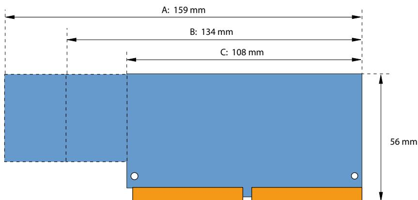
Fig. 82 Dimensiones de las tarjetas de interfaz (diseño A, B, C)
