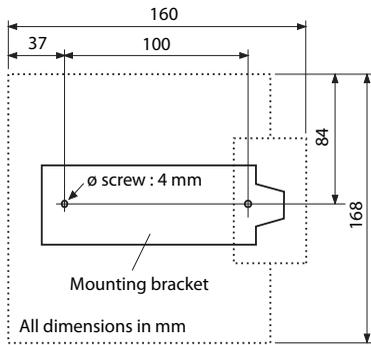
Fig. 65 Distancias para el montaje mural del soporte
