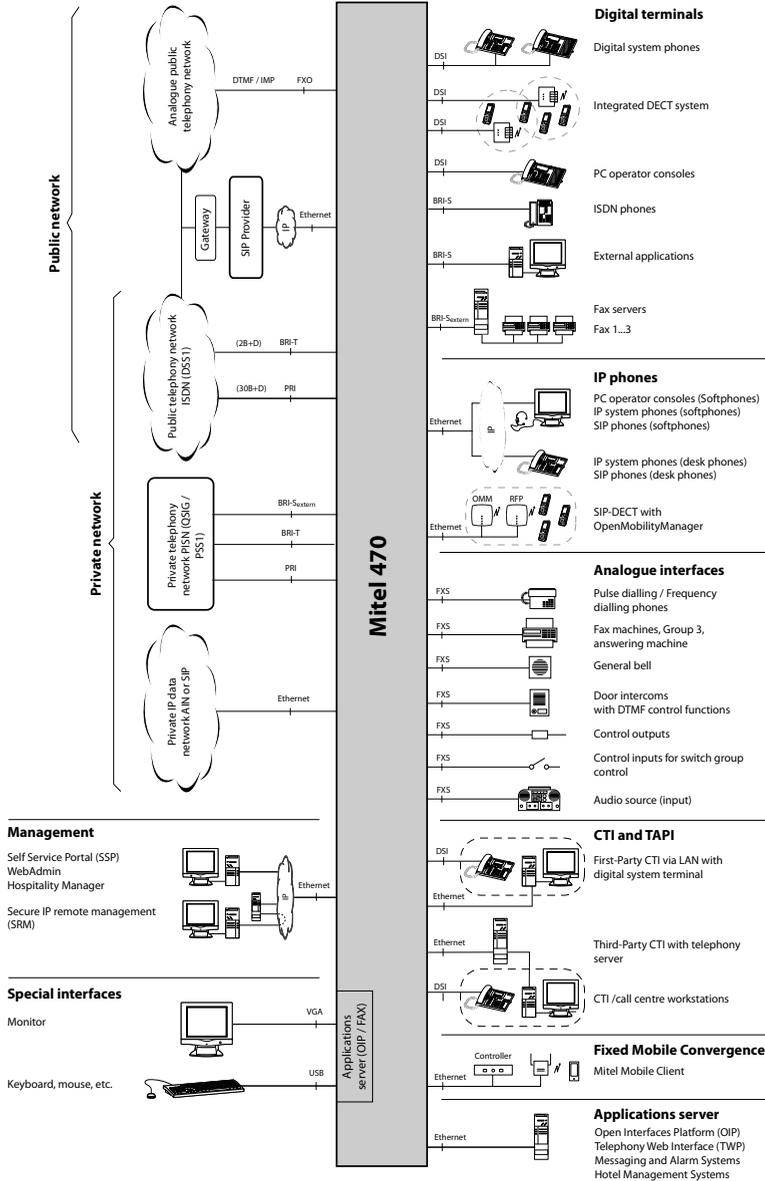
Fig. 4 Visión general de las interfaces con posibles equipos terminales
