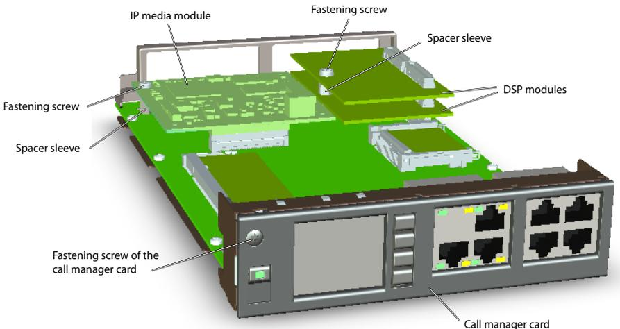
Fig. 27 Módulos de sistema en la tarjeta gestor de llamadas
