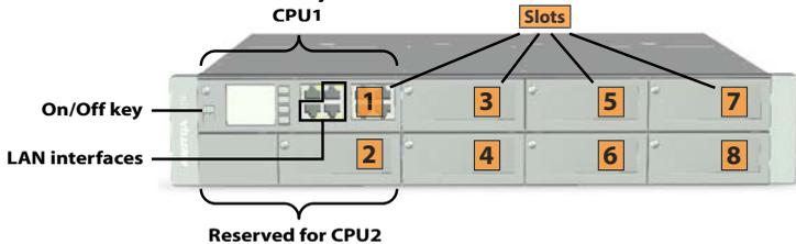
3. Instale los módulos del sistema (módulos DSP o un módulo EIP), en caso de haberlos:
