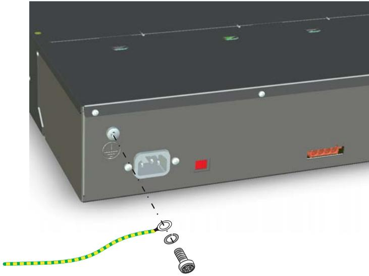
Fig. 21 Conexión a tierra
