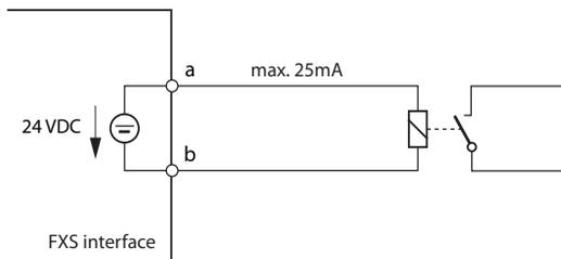
Fig. 62 Conexión para el modo FXS: Salida de control
