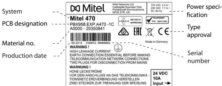
Fig. 87 Placa de datos de servidor de comunicaciones Mitel 470
