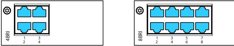
Fig. 35 Posibilidades de conexión para interfaces de red BRI
