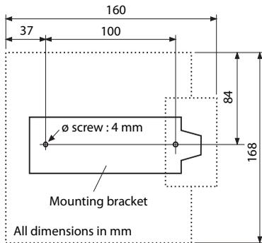
Fig. 70 Distancias para el montaje mural del soporte
