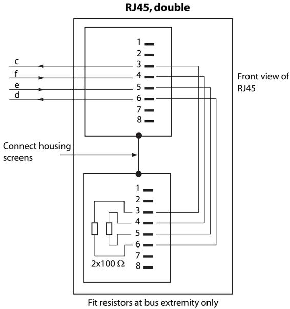
Fig. 55 Conexión RJ45, toma doble
