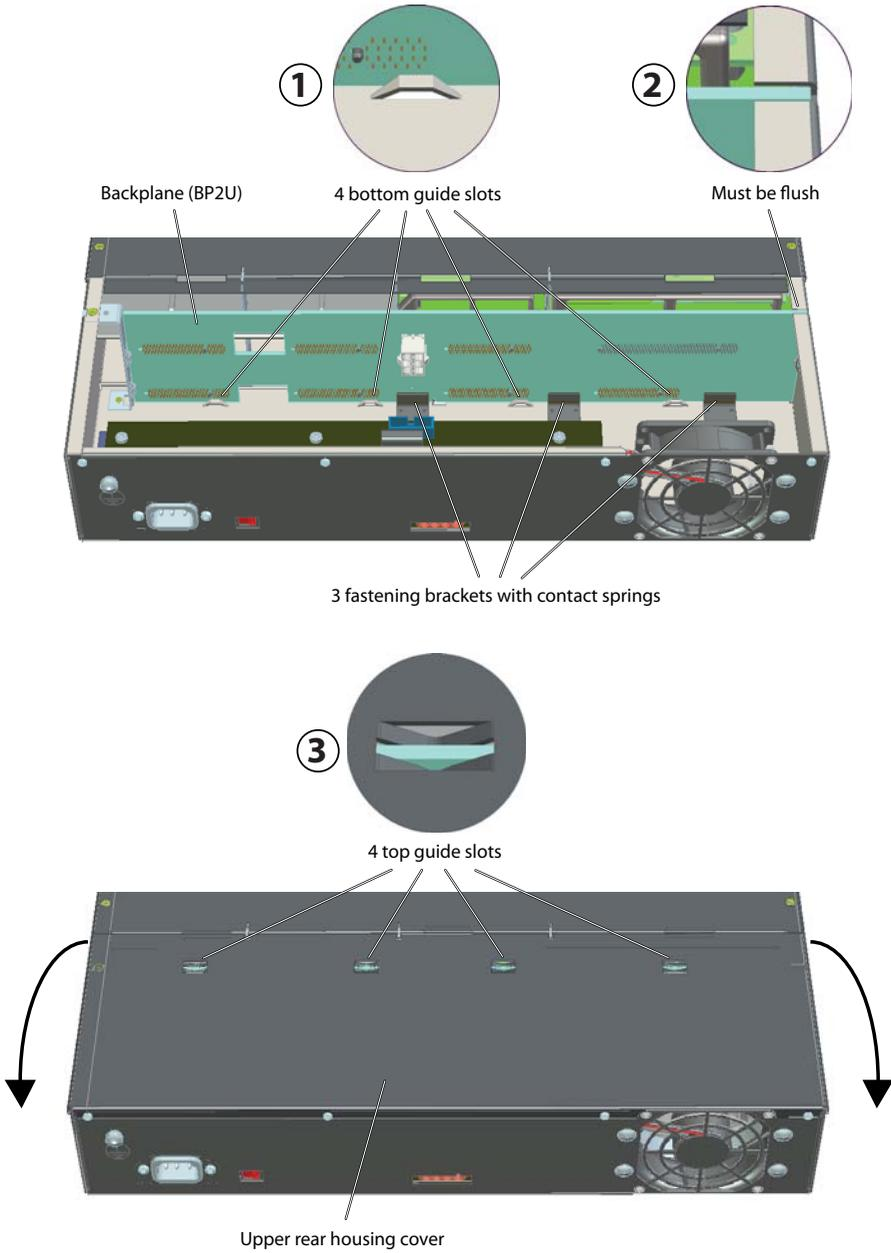
Fig. 20 Colocación correcta de la placa posterior BP2U
