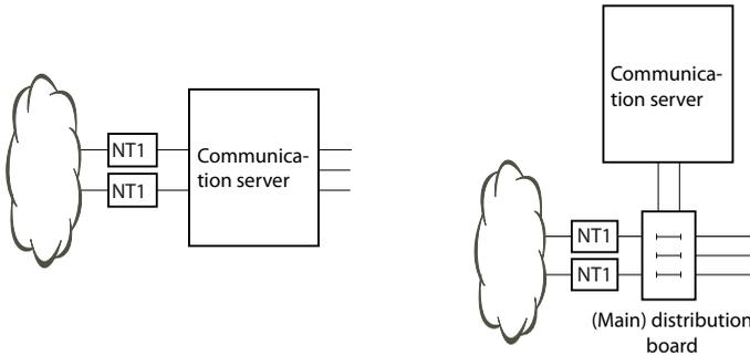
Fig. 29 Cableado directo (izquierda) y cableado indirecto (derecha)
