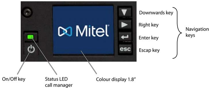
Fig. 82 Panel de visualización y control de Mitel 470
