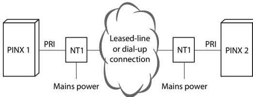
Fig. 43 Acceso primario PRI, conectado mediante línea dedicada o conexión telefónica
