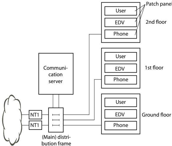
Fig. 32 Conexión a un UBC a través de una placa de distribución principal (ejemplo)
