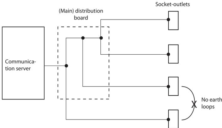
Fig. 23 Principio de la estructura en árbol
