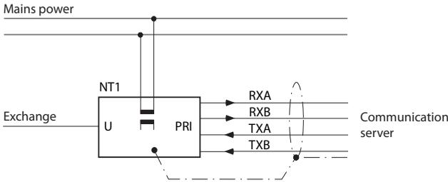
Fig. 40 Interfaz de acceso primario PRI en NT1
