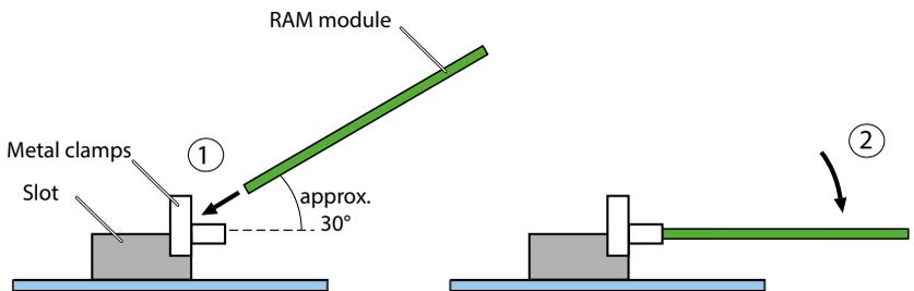
Fig. 79 Cambiar el módulo RAM
