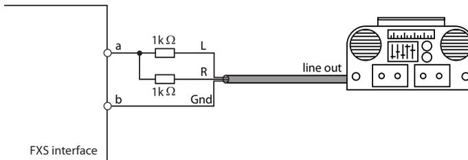
Fig. 61 Conexión para el modo FXS: Fuente de audio externa:
