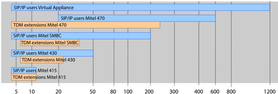
Fig. 2 Capacidad de expansión máxima para usuarios con teléfonos SIP/IP y extensiones TDM (FXS, DSI, BRI-S)
