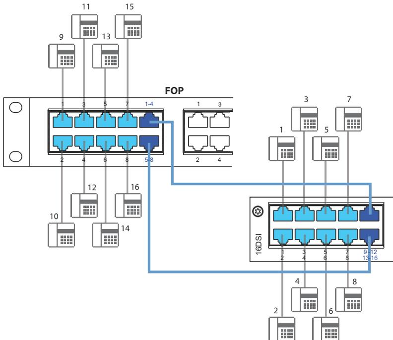
Fig. 66 Conexión de los enchufes asignados en grupos de cuatro a través de la banda conectora FOP
