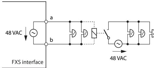
Fig. 64 Conexión para el modo FXS: Llamada general
