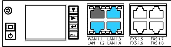
Fig. 67 Posibilidades de conexión para interfaces Ethernet
