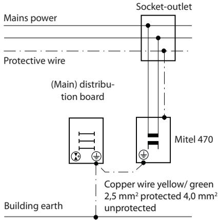
Fig. 22 Puesta a tierra del servidor de comunicaciones en caso de conexión directa y conexión indirecta
