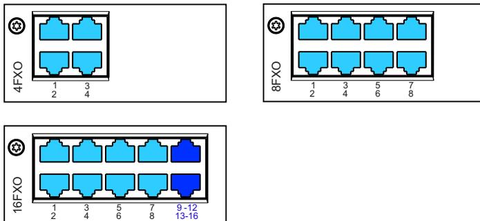
Fig. 44 Posibilidades de conexión para interfaces de red FXO
