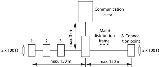
Fig. 51 Bus S, corto, en forma de V
