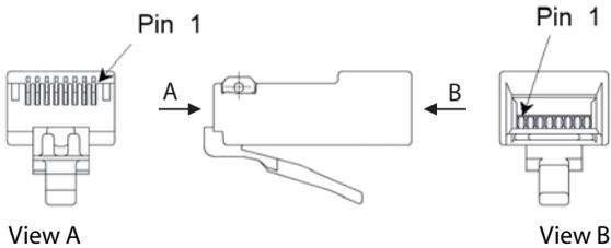
Fig. 31 Numeración de pines de un conector RJ45
