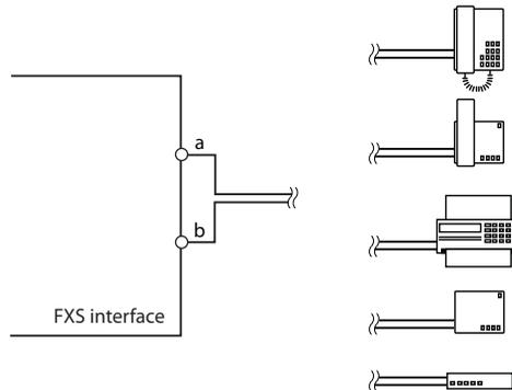
Fig. 57 Conexión para el modo FXS: Teléfono/fax
