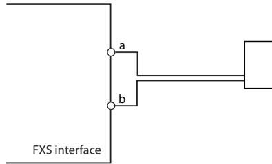
Fig. 60 Conexión para el modo FXS: Intercomunicador de puerta a 2 hilos
