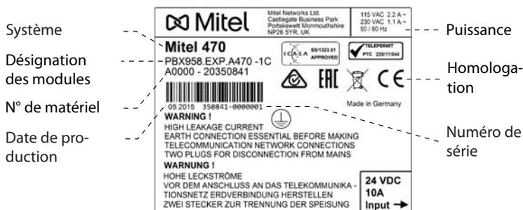
Fig. 87 Plaquette signalétique Mitel 470 du serveur de communications
