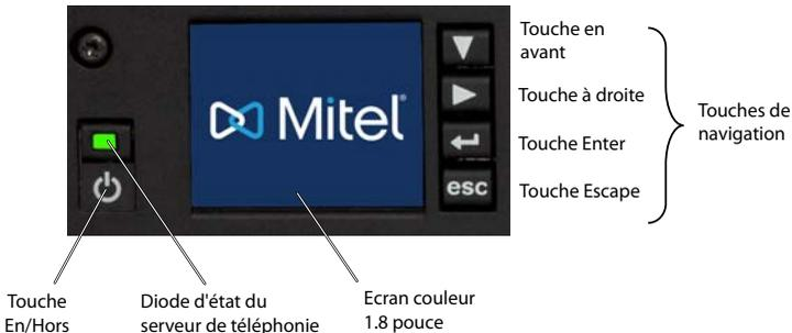
Fig. 82 Panneau d'affichage et de commande Mitel 470
