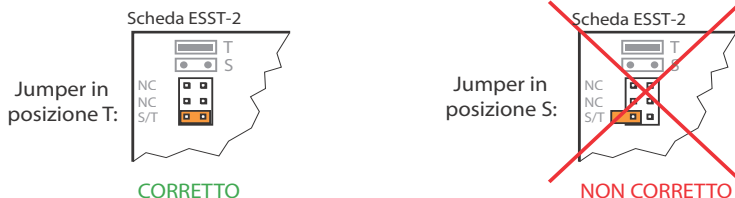
Fig. 24 Posizione dei jumper sulla scheda ESST
