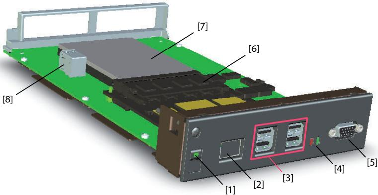
Fig. 16 Schnittstellen, Anzeige- und Bedienelemente der Applikationskarte
