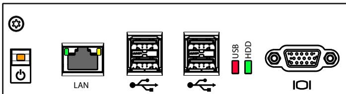
Fig. 84 Status-LEDs des Applikationsserver
