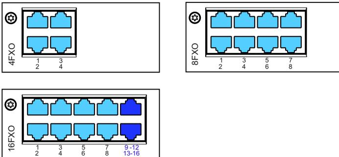
Fig. 44 Anschlussmöglichkeiten FXO-Netzschnittstellen
