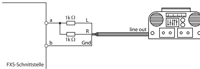
Fig. 61 Beschaltung für FXS-Modus: Externe Audioquelle
