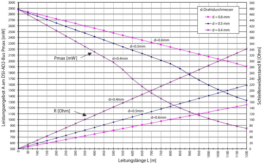
Fig. 47 Verfügbare Leistung Fall A am DSI-AD2-Bus
