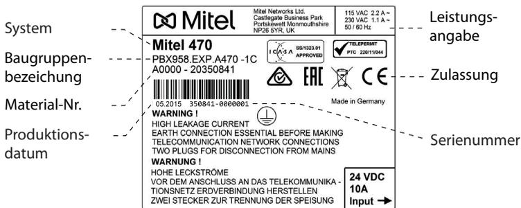
Fig. 87 Typenschild Mitel 470 Kommunikationsserver
