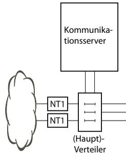
Fig. 30 Anschluss über Hauptverteiler
