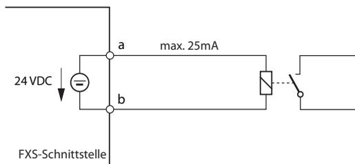
Fig. 62 Beschaltung für FXS-Modus: Steuerausgang
