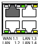
Fig. 68 Status LED Ethernet-Schnittstellen
