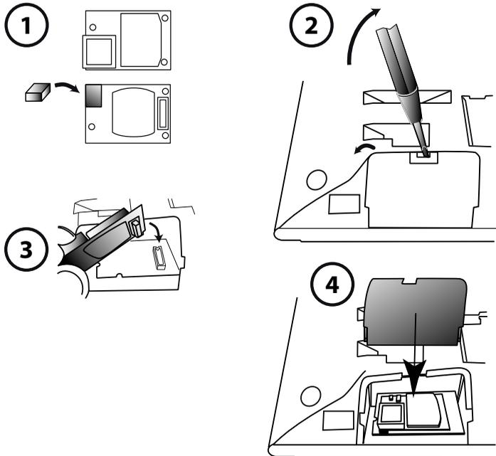
Fig. 69 Montage Bluetooth-Modul
