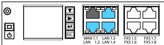
Fig. 67 Anschlussmöglichkeiten Ethernet-Schnittstellen
