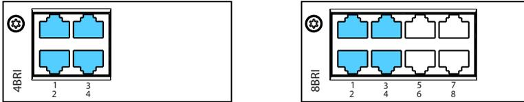
Fig. 49 Anschlussmöglichkeiten BRI-S-Endgeräteschnittstellen
