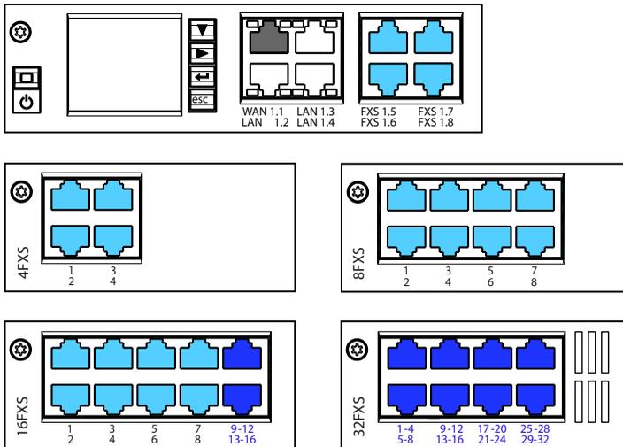
Fig. 56 Anschlussmöglichkeiten FXS-Endgeräteschnittstellen
