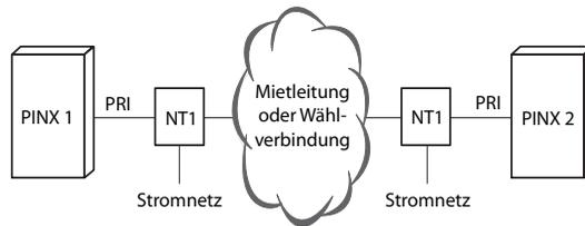
Fig. 43 Primärratenanschluss PRI Vernetzung mit Mietleitung oder Wählverbindung
