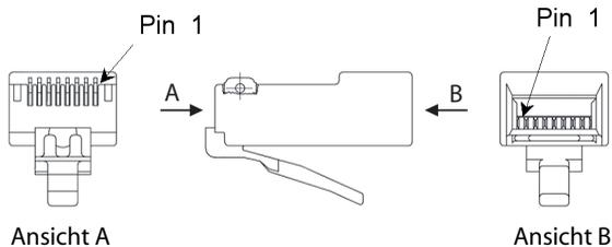
Fig. 31 Pin-Nummerierung RJ45-Stecker
