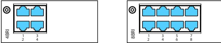
Fig. 35 Anschlussmöglichkeiten BRI-Netzchnittstellen
