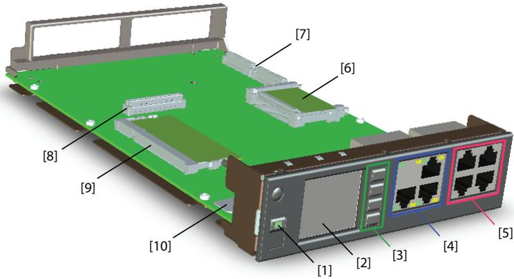
Fig. 9 Schnittstellen, Anzeige- und Bedienelemente der Call-Manager-Karte CPU1
