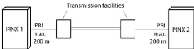
**Table 41: Beschaltung Primärratenanschluss PRI Vernetzung mit Übertragungseinrichtung**
