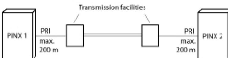
**Table 51: Beschaltung Primärratenanschluss PRI Vernetzung mit Übertragungseinrichtung**
