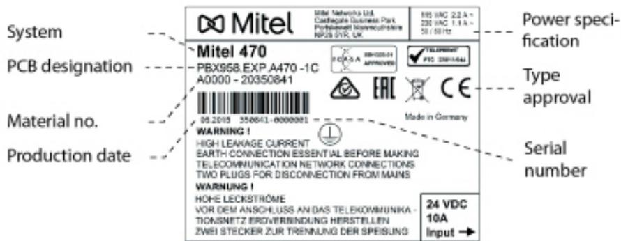
Figure 58: Bezeichnungskleber (Beispiel Schnittstellenkarte)
