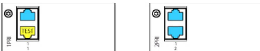
With card 1PRI/1PRI-T1<sup>50</sup> die PRI-Schnittstelle wird zu Testzwecken parallel zu beiden RJ45-Buchsen geführt.
