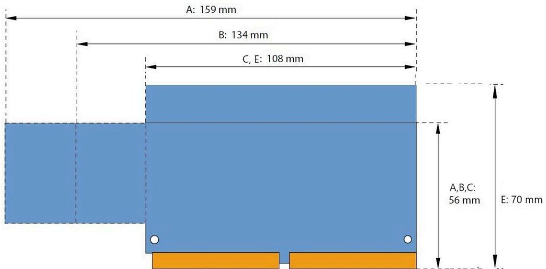
Figure 71: Dimensiones de los módulos de sistema (diseño D)
