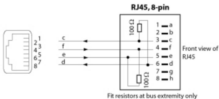
Figure 47: Conexión RJ45, toma doble
