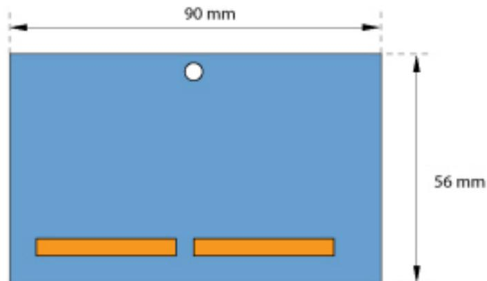
Figure 72: Dimensiones del adaptador de cableado (dibujo F)
