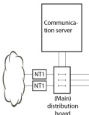
Los enchufes de interfaz en el panel frontal y en el panel de abanico (FOP), donde corresponda, se conectan con el marco de distribución (principal) o los paneles de conexión mediante cables de conexión o cables de sistema prefabricados (consulte [Descripción general del equipo](#)).
