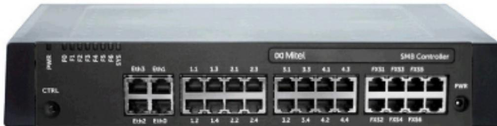
Los servidores de comunicaciones pueden ampliarse con tarjetas de interfaz y módulos de sistema. El Mitel SMB Controller se envía equipado con un módulo CPU, 6 interfaces de terminal analógicas y 4 conexiones Gbit LAN.
