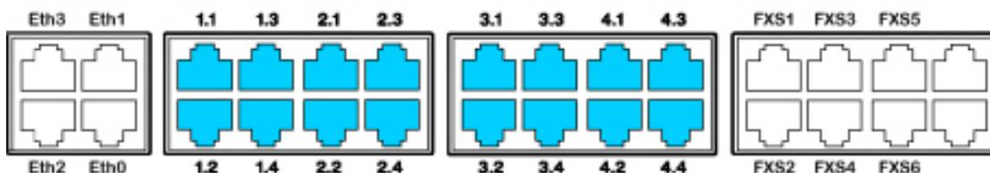
En las tarjetas con 16 interfaces, los puertos RJ45 9 a 16 se asignan de forma múltiple. Las señales se pueden volver a dividir en tomas RJ45 individuales utilizando cables de conexión y el panel de distribución FOP (consulte el [panel de distribución FOP](#)) o con cables de conexión asignados 8 veces (consulte, por ejemplo, [cable de sistema prefabricado 4 x RJ45](#)).
