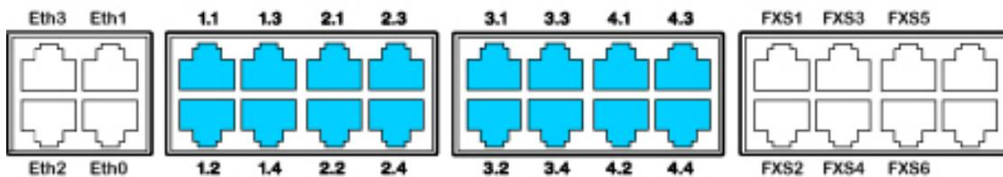
En las tarjetas con 16 interfaces, los puertos RJ45 9 a 16 se asignan de forma múltiple. Las señales se pueden volver a dividir en tomas RJ45 individuales utilizando cables
