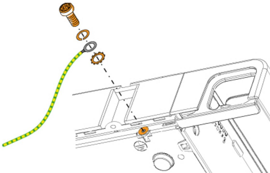
Figure 18: Puesta a tierra del servidor de comunicaciones en caso de conexión indirecta y conexión directa
