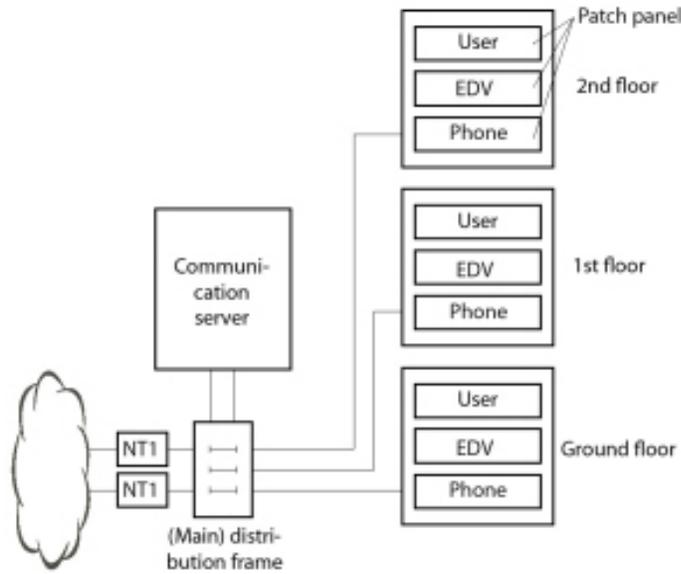
Figure 24: Conexión a un UBC a través de un centro de cableado (ejemplo)
