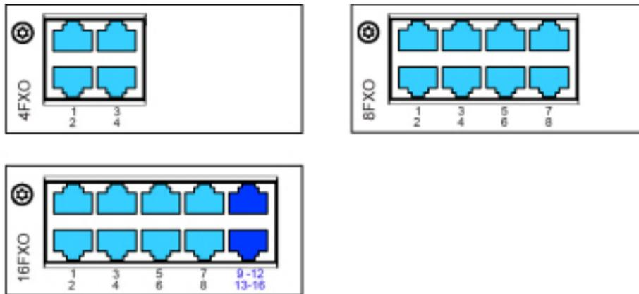
En las tarjetas con 16 interfaces, los puertos RJ45 9 a 16 se asignan de forma múltiple. Las señales se pueden volver a dividir en tomas RJ45 individuales utilizando cables de conexión y el panel de distribución FOP (consulte el [panel de distribución FOP](#)) o con cables de conexión asignados 8 veces (consulte, por ejemplo, [cable de sistema prefabricado 4 x RJ45](#)).
