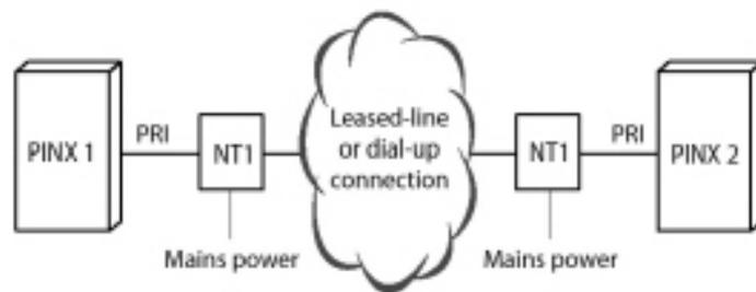
**Table 52: Cableado para la interfaz de acceso primario PRI, conectado mediante línea dedicada o conexión telefónica**
