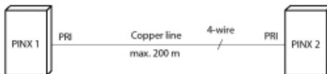
**Table 50: Cableado para el acceso primario PRI, conectado mediante cable de cobre**
