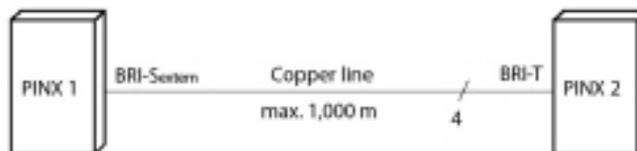
**Table 46: Conexión de la interfaz de acceso básico BRI-S externo, conectada con cable de cobre**
