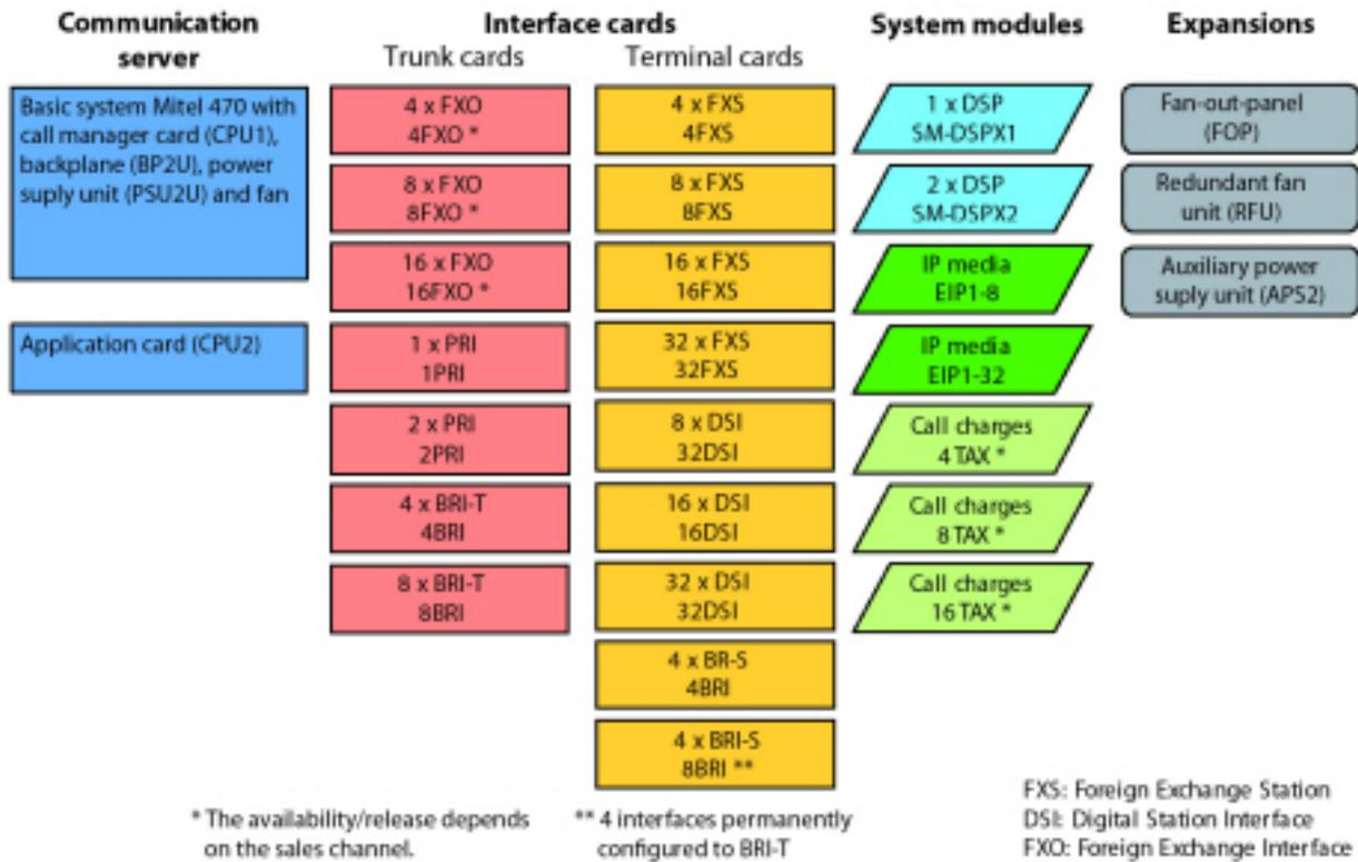
El sistema básico Mitel 470 se puede ampliar no solo con las tarjetas de interfaz y los módulos de sistema sino también con una tarjeta de aplicaciones (CPU2). La tarjeta de aplicaciones se suministra con la preinstalación de sistema operativo, comunicaciones unificadas y aplicaciones multimedia.
