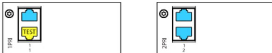
Con tarjeta 1PRI / 1PRI-T1<sup>50</sup> la interfaz PRI se enruta en paralelo a ambos enchufes RJ45 para fines de prueba.
