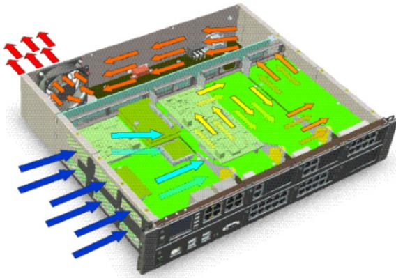
La velocidad del ventilador depende de la temperatura ambiente, el número de tarjetas y módulos y la carga del servidor de comunicaciones, y se adapta continuamente a la temperatura dentro de la carcasa.
