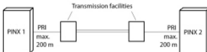
**Table 51: Cableado para el acceso primario PRI, conectado mediante equipo de transmisión**
