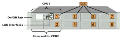
3. Instale los módulos del sistema (módulos DSP o un módulo EIP), en caso de haberlos:
