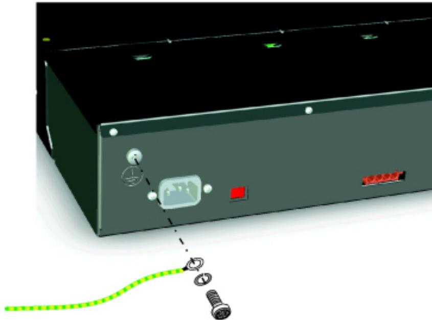
Figure 21: Puesta a tierra del servidor de comunicaciones en caso de conexión directa y conexión indirecta
