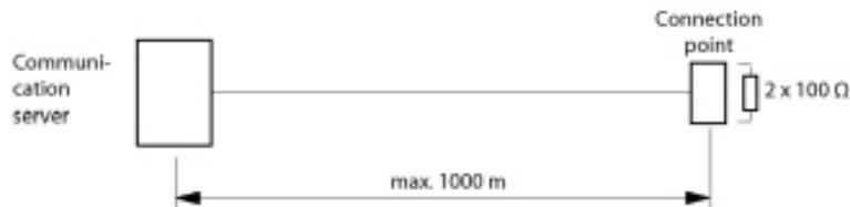
Il est possible de relier des distances supérieures (jusqu'à 8 km) avec une prolongation usuelle de bus S.
