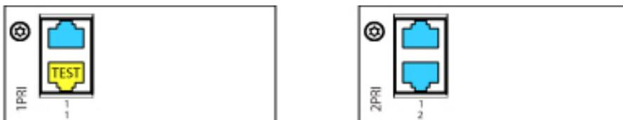
Avec la carte 1PRI/1PRI-T1<sup>50</sup> l'interface PRI est acheminé en parallèle sur les deux prises RJ45 pour besoin de test.
