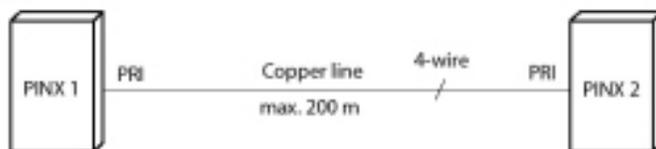
**Table 50: Connexion de la mise en réseau à l'aide de l'accès primaire T2 avec ligne de cuivre**
