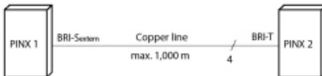
Table 46: Connexion de l'accès de base S0 externe: Mise en réseau avec ligne de cuivre
