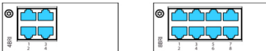
Figure 32: Possibilità di collegamento delle interfacce di rete BRI
