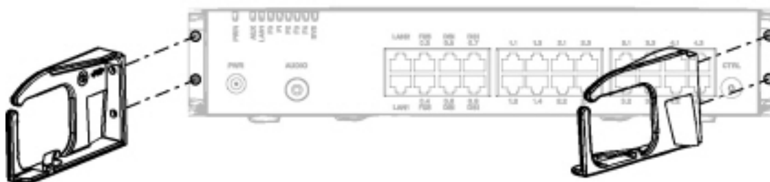
Figure 4.8: Installeren van de beugels voor de kabelafdekking
