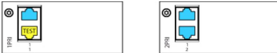
Mit Karte 1PRI/1PRI-T1<sup>50</sup> die PRI-Schnittstelle ist zu Testzwecken parallel auf beide RJ45-Buchsen geführt.
