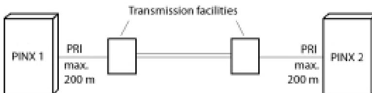
**Table 51: Beschaltung Primärratenanschluss PRI Vernetzung mit Übertragungseinrichtung**
