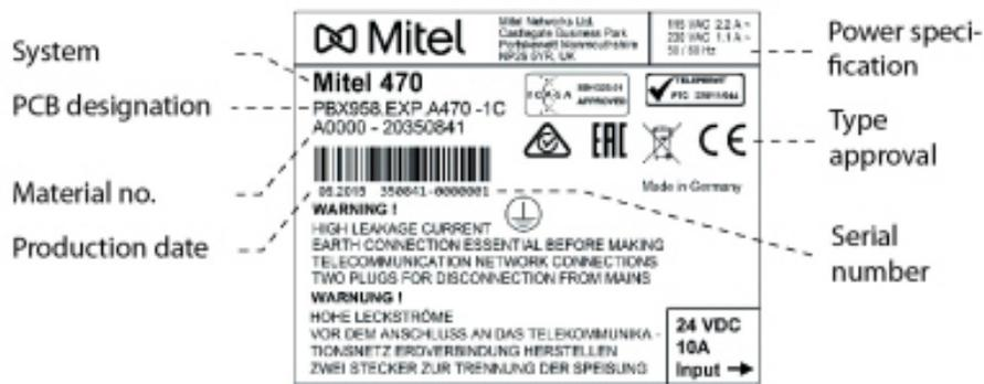
Figure 60: Bezeichnungskleber (Beispiel Schnittstellenkarte)
