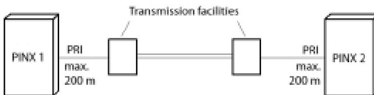
**Table 43: Beschaltung Primärratenanschluss PRI Vernetzung mit Übertragungseinrichtung**
