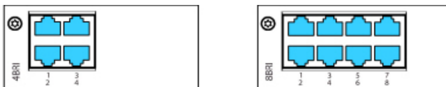
Figure 31: Posibilidades de conexión para interfaces de red BRI
