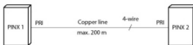
Figure 37: Acceso primario, conectado mediante cable de cobre
