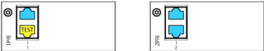
Figure 35: Posibilidades de conexión para interfaces de red PRI
