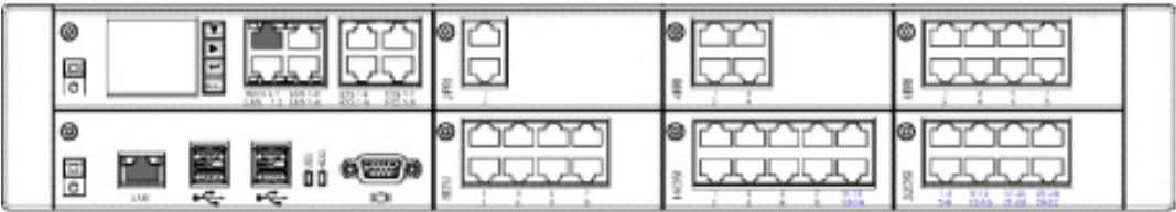
Figure 30: Interfaces en el panel frontal con designación de puertos (ejemplo)
