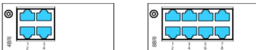
Figure 31: Possibilités de raccordement des interfaces réseau S0/T0
