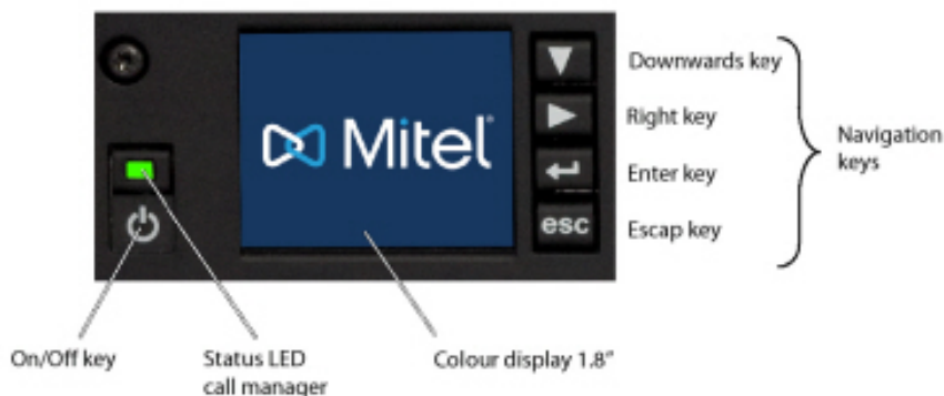
Figure 54: Affichage du serveur de communication Mitel 470 et panneau de contrôle
