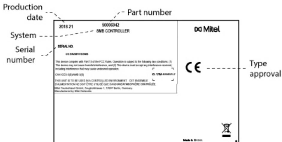
Figure 79: Autocollant d'identification (exemple de la carte d'interface)
