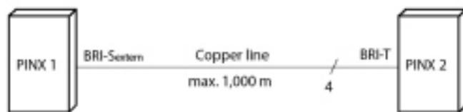
**Table 38: Connexion de l'accès de base S0 externe: Mise en réseau avec ligne de cuivre**
