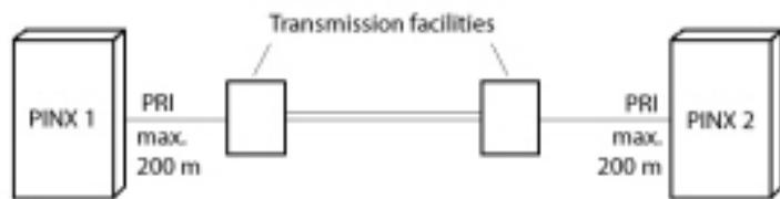
**Table 43: Connexion de la mise en réseau à l'aide de l'accès primaire RNIS T2 avec dispositif de transmission**
