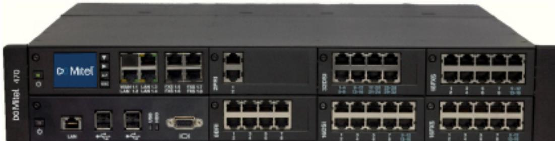
Il server di comunicazione Mitel 470 comprende alla consegna una scheda processore inseribile (scheda gestore chiamate) con un display a colori, 4 interfacce di terminale analogiche e 3 connessioni LAN da 3 Gbit. Come opzione è possibile inserire una seconda scheda processore (scheda di applicazioni). Su di essa è preinstallato il server di applicazioni per servizi Unified Communications e servizi multimedia.
