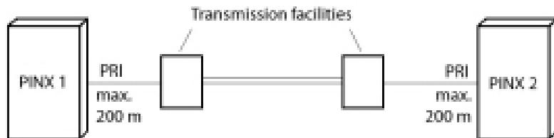
**Table 77: Beschaltung Primärratenanschluss PRI Vernetzung mit Übertragungseinrichtung**
