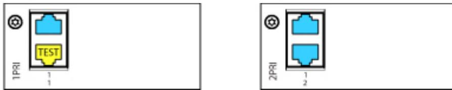
Mit Karte 1PRI/1PRI-T1<sup>122</sup> die PRI-Schnittstelle ist zu Testzwecken parallel auf beide RJ45-Buchsen geführt.
