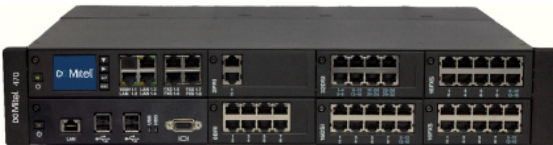
Der Kommunikationsserver Mitel 470 enthält im Auslieferzustand eine steckbare Prozessorkarte (Call-Manager-Karte) mit einem Farbdisplay, 4 analogen Endgeräteschnittstellen und 3 Gbit-LAN-Anschlüssen. Optional lässt sich eine zweite Prozessorkarte (Applikationskarte) stecken. Sie enthält den vorinstallierten Applicationserver für Unified Communications und Multimedia-Dienste.
