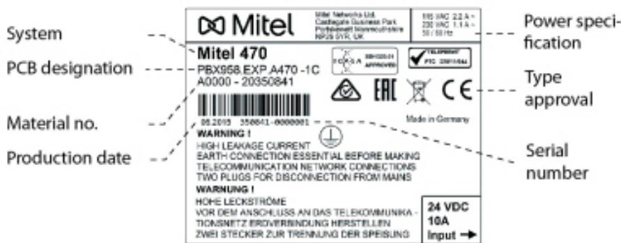
Figure 124: Bezeichnungskleber (Beispiel Schnittstellenkarte)
