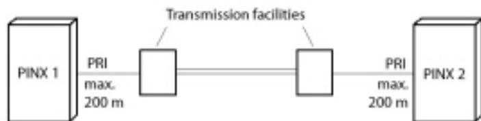
Tabla 51: Cableado para el acceso primario PRI, conectado mediante equipo de transmisión
