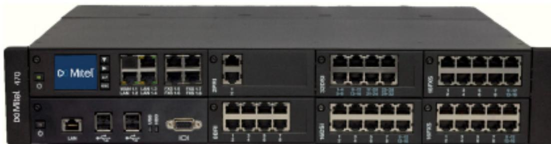
El servidor de comunicaciones de Mitel 470 se envía con una tarjeta de conexión del procesador (llamada tarjeta Manager o Gestor) con pantalla en color, 4 interfaces de terminal analógicas y 3 conexiones Gbit LAN. Se puede incluir una segunda tarjeta de CPU (tarjeta de aplicaciones) de manera opcional. Contiene el servidor de aplicaciones preinstalado para comunicaciones unificadas y servicios multimedia.
