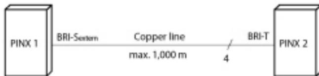
Tabla 46: Conexión de la interfaz de acceso básico BRI-S externo, conectada con cable de cobre
