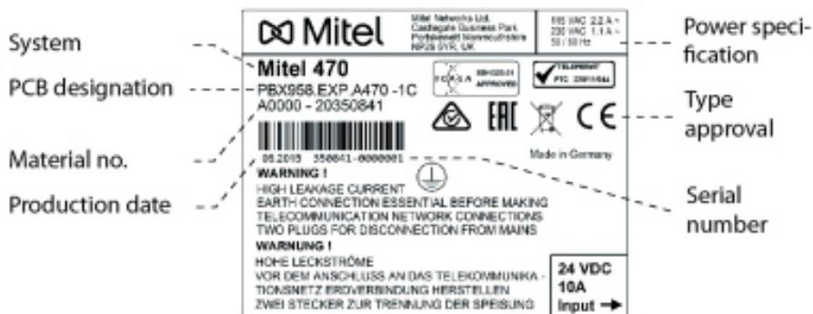
Illustration 59 : Autocollant d'identification (exemple de la carte d'interface)
