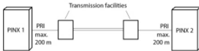
**Tableau 51 : Connexion de la mise en réseau à l'aide de l'accès primaire RNIS T2 avec dispositif de transmission**
