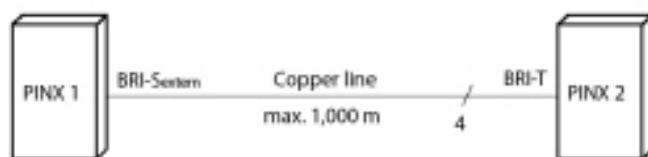
Tableau 38 : Connexion de l'accès de base S0 externe: Mise en réseau avec ligne de cuivre
