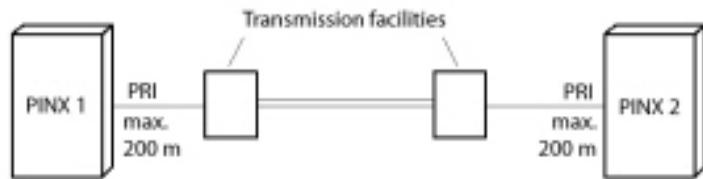
Tableau 43 : Connexion de la mise en réseau à l'aide de l'accès primaire RNIS T2 avec dispositif de transmission
