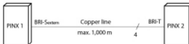
**Table 72: Cablaggio accesso base BRI-Sest, collegamento in rete con conduttori in rame**
