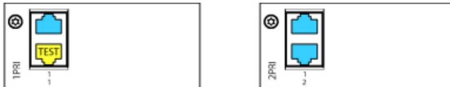
Con la scheda 1PRI/1PRI-T1<sup>122</sup> l'interfaccia PRI viene instradata in parallelo su entrambi i connettori RJ45 a scopi di test.
