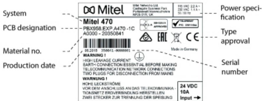
Figure 124: Etichetta di identificazione (esempio della scheda di interfaccia)
