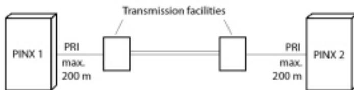
**Table 77: Cablaggio accesso primario PRI, collegamento in rete con dispositivo di trasmissione**
