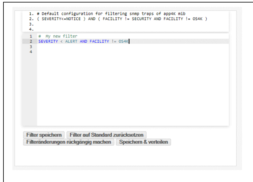
Figure 11 SNMP-Konfiguration – Hostsystemereignisse – Zuletzt gespeicherter Filter
