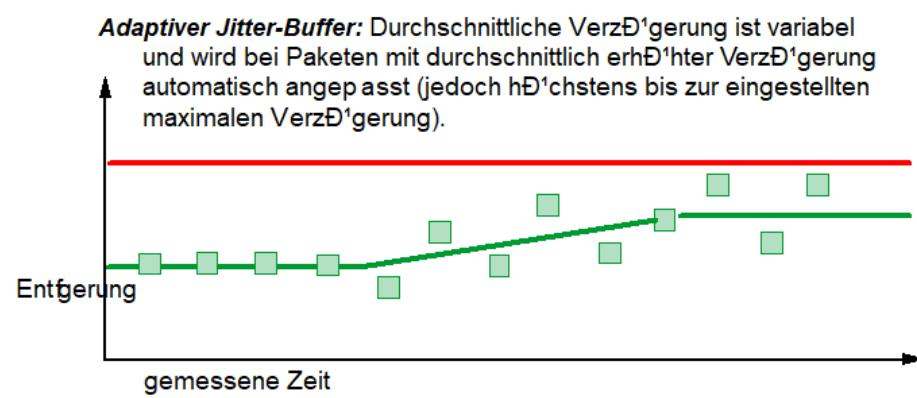
Die einstellbare durchschnittliche Verzögerung (grüne Linie) ist beim adaptiven Jitter-Buffer lediglich der Startwert.
