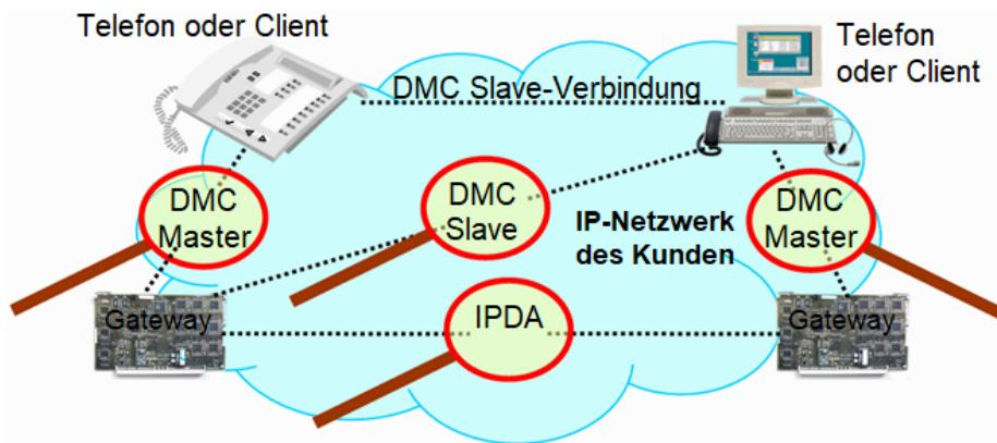
Ein Secure Trace kann für die folgenden Verbindungen aufgezeichnet werden:
