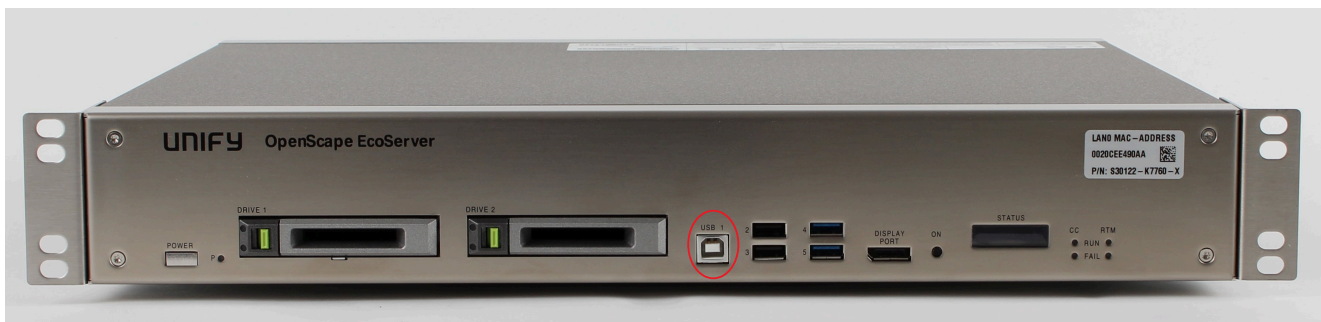
Figure 1: TAP-Verbindung auf dem EcoServer
