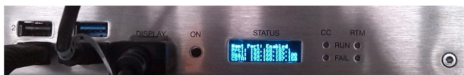
Figure 5: LCD-Display mit Anzeige des Management-Port-Status - Enabled (aktiviert) / Disabled (deaktiviert)
