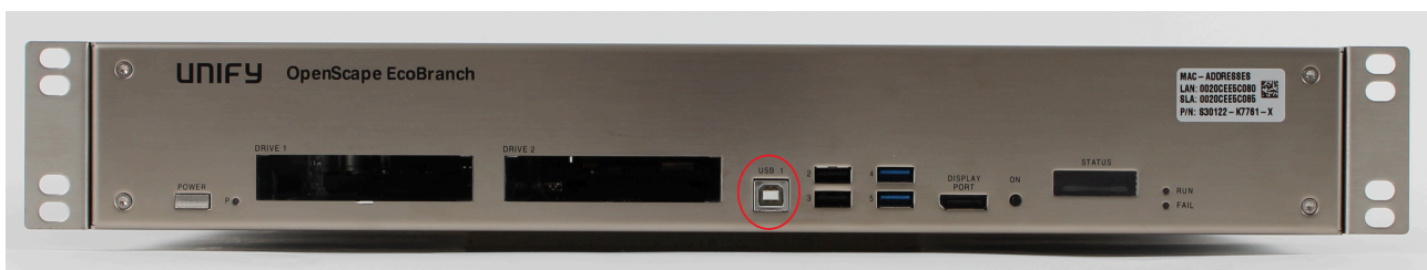
Figure 2: TAP-Verbindung bei EcoBranch
