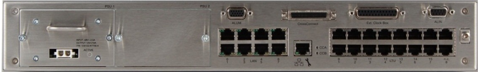
Abbildung 111: DC-Stromversorgung des EcoServers
