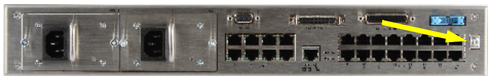
Figure 88: EcoServer - raccordement d'équipotentialité
