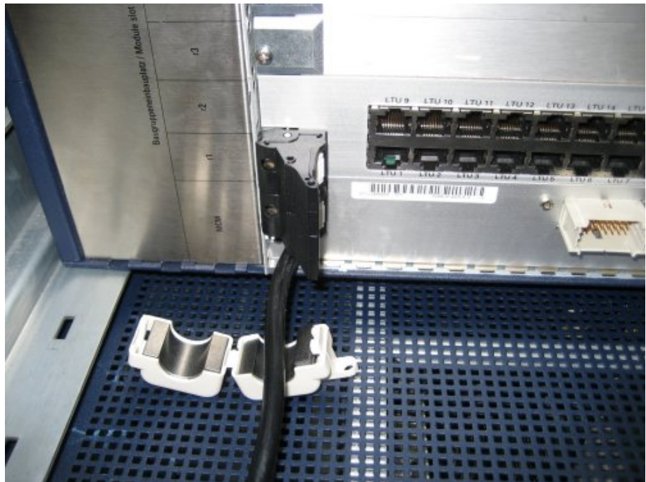
Figure 36: Tore de ferrite ouvert sous le câble d'alimentation
