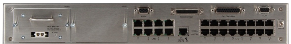
Figure 111: Alimentation électrique CC de l'EcoServer
