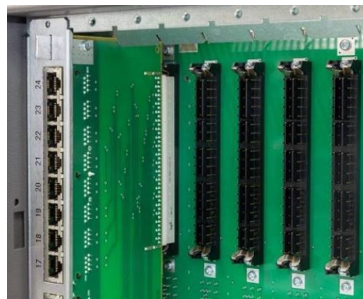
Figure 13: Tableau de connexions avec prise CHAMP (NPPSC, S30807-Q6626-X)
