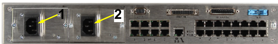
Figure 104: Alimentation électrique CA de l'EcoServer
