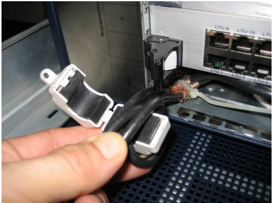
Figure 43: Passage du câble de raccordement dans le tore de ferrite (boucle)
