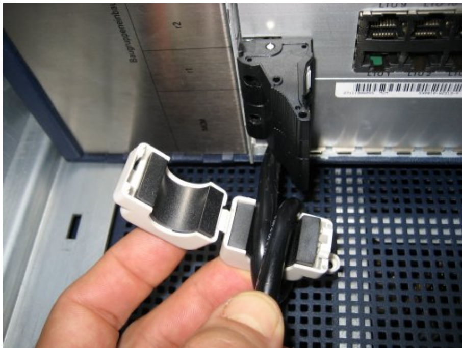
Figura 48: Laço do cabo AC no núcleo de ferrite
