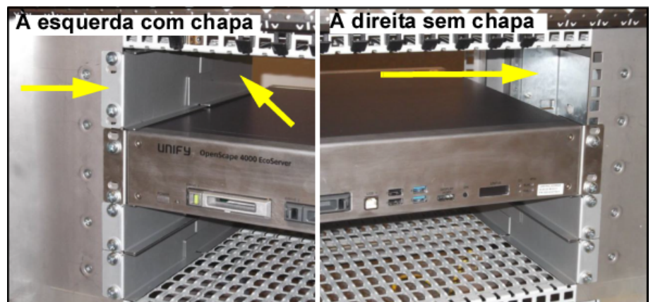
Figura 44: Chapas de guia do ar sobre o EcoServer na operação Simplex
