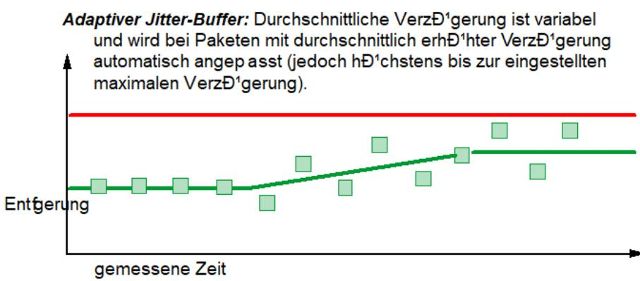
Die einstellbare durchschnittliche Verzögerung (grüne Linie) ist beim adaptiven Jitter-Buffer lediglich der Startwert.
