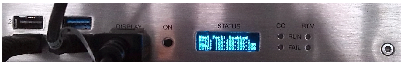
Figure 5: LCD-Display mit Anzeige des Management-Port-Status - Enabled (aktiviert) / Disabled (deaktiviert)
